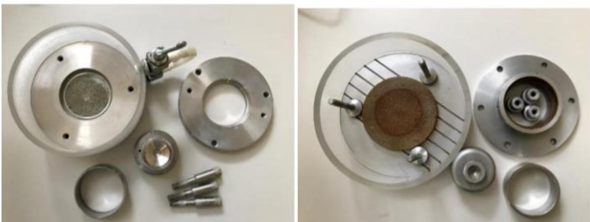
*Figura 26 Componenti cella edometrica di carico Tecnotest (a sinistra), Wikeham-Farrance (a destra)*
