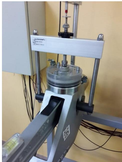
*Figura 35 Prova edometrica*
