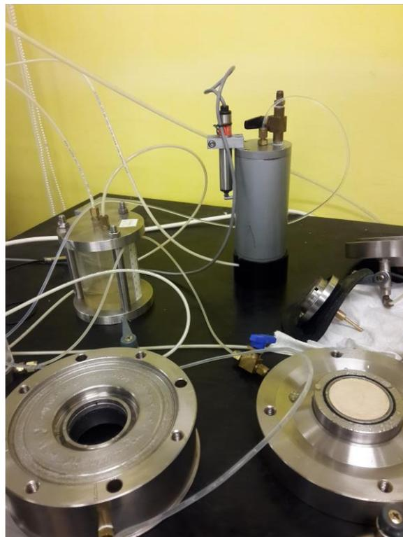
*Figura 23 Componenti dell'edometro a suzione controllata*
