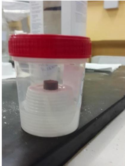
*Figura 15 Schema di provini all'interno di contenitori per tecnica equilibrio di vapore*
