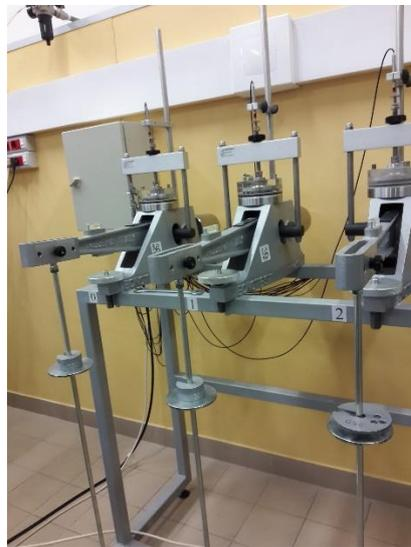
*Figura 27 Telaio edometri Tecnotest*
