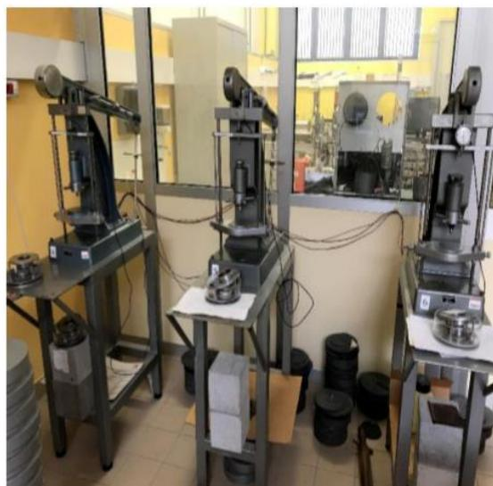
*Figura 28 Telaio edometri Wikeham-Farrance*
