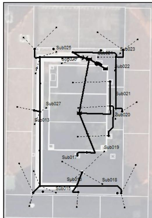
Figura 5.4: Schematizzazione dei subcatchments della pavimentazione mediante SWMM
