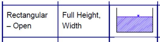
Figura 5.5: Rappresentazione della sezione trasversale del canale aperto (Rossman, 2015)
