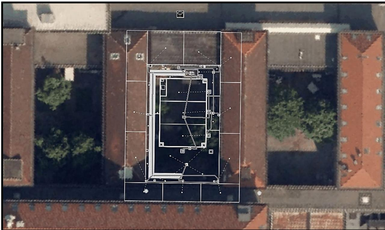
Figura 5.1: Schematizzazione del Laboratorio green-court-lab mediante il codice SWMM
