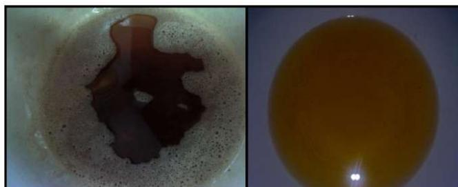
Figura 41 Campione di WCO non filtrato (a sinistra) e di WCO dopo il processo di filtraggio (a destra) (Asli et al., 2012).
