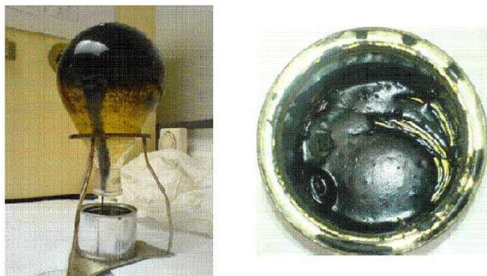
Figura 9 Estratto di Soxhlet da microalghe (Chailleux et al., 2012).
