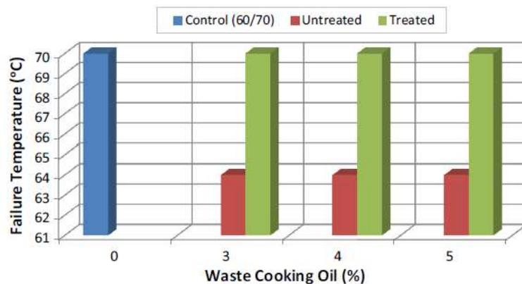
Figura 56 Temperatura di rottura per leganti con WCO trattati e WCO non trattati (Wan Nur Aifa Wan Azahar et al., 2016).
