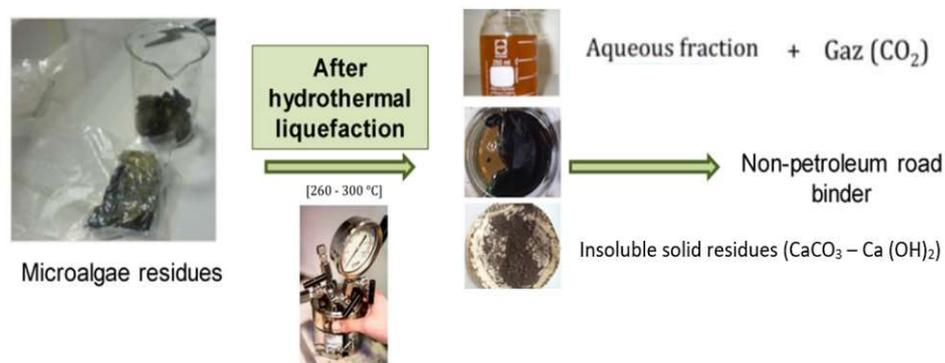
Figura 12 Procedimento di HTL con residui di micro-alghe (Audo et al., 2014).
