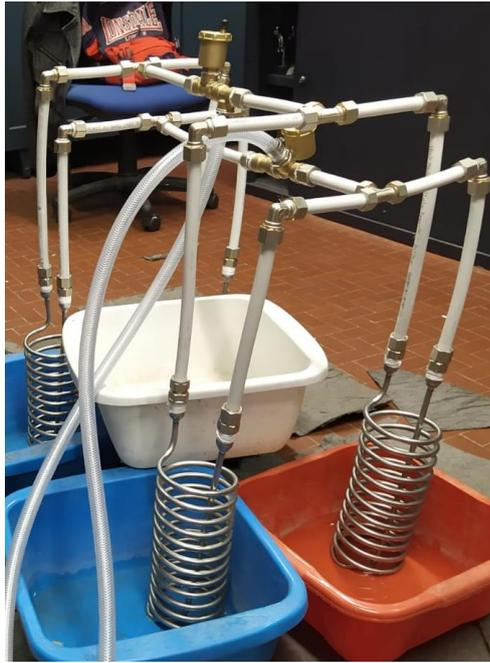
Figura 5.21 – Fotografia del sistema di raffreddamento fuori dal serbatoio.
