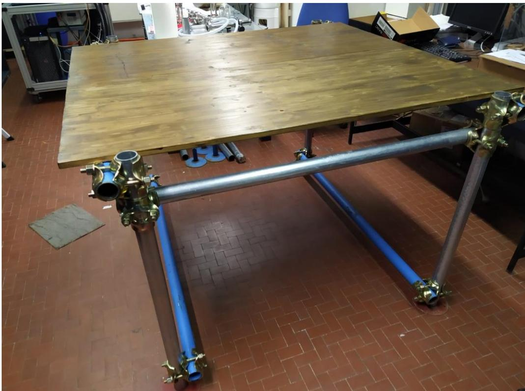
**Figura 5.2 – Fotografia dell'impalcatura e del piano di lavoro in fase di realizzazione su cui poggia l'impianto cavitazionale.**
