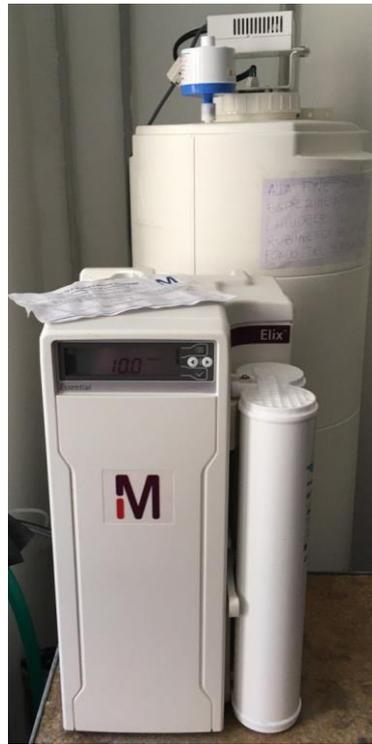
Figura 5.14 – Fotografia dello strumento che produce acqua ultrapura e serbatoio di accumulo.
