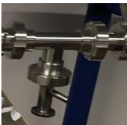
Figura 5.23 – Fotografia dello scarico con valvola a sfera.
