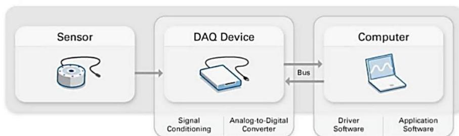
Figura 5.32 – Schematizzazione hardware DAQ.
