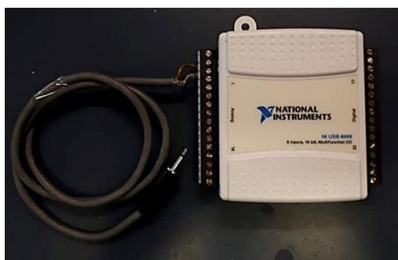
Figura 5.33 – Scheda acquisizione dati NATIONAL INSTRUMENT NI USB-6009.
