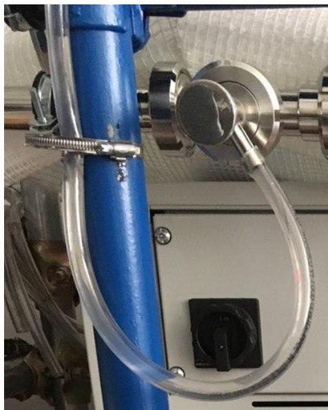
Figura 5.28 – Fotografia del piezometro in funzione grazie alla valvola di scarico 3.
