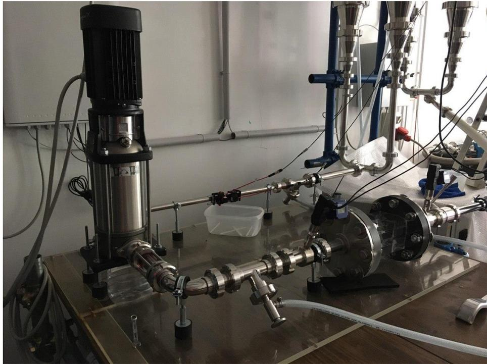
Figura 5.25 – Fotografia dell'impianto idraulico con le tubazioni di scarico in gomma.
