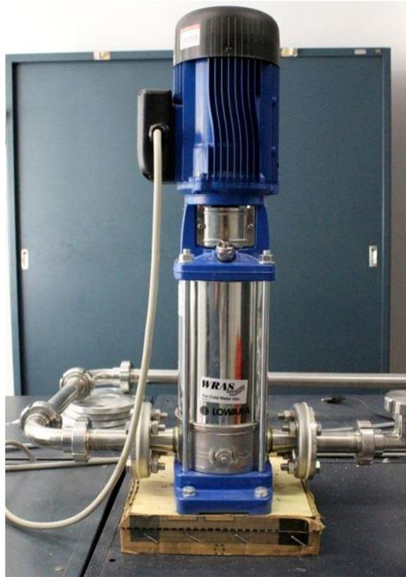
Figura 5.11 – Fotografia di elettropompa centrifuga multistadio verticale Lowara 3SV11.
