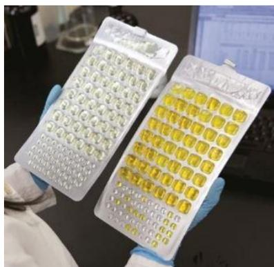
**Figura 7.1 – Confronto colorimetrico tra comparatore e campione incubato.**
