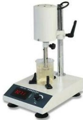
**Figura 3.5 – Omogeneizzatore ad alta velocità. (Fonte: Garofano, 2016)**
