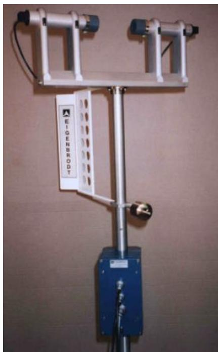
Figura 4.4: Optical disdrometer ODM 470, Eigenbrodt.<sup>4</sup>
