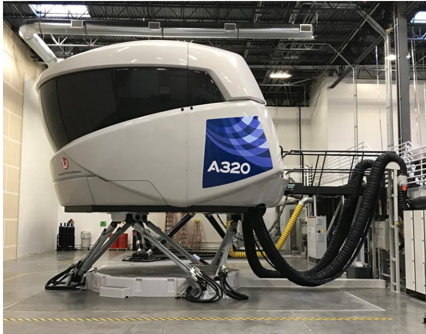
Figura 1.4 – Simulatore di volo full scale del velivolo A320 (Fonte: [2.5])
