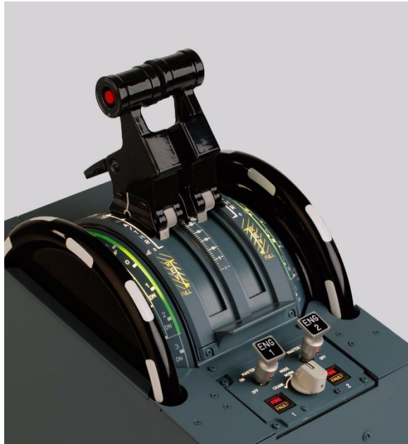
Figura 5.18 - Manette dei propulsori, regolatori per il trim di stabilizzatore e pannello di accensione dei propulsori
