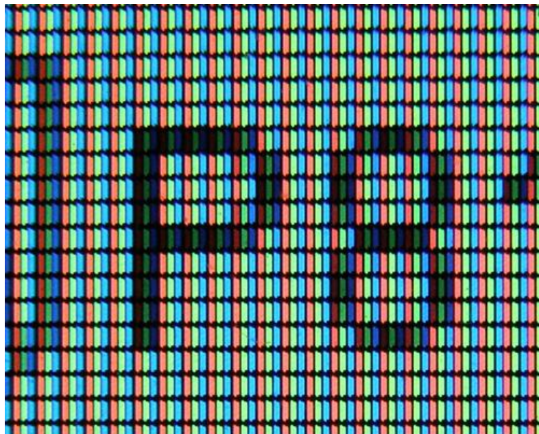
Figura 3.9 - Vista ingrandita di uno schermo in cui è possibile osservare i tre subpixels costituenti il singolo pixel RGB
