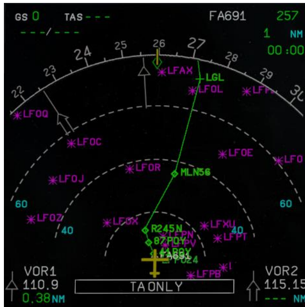
Figura 5.5 – Multifunctional Display nella configurazione di Navigation Display
