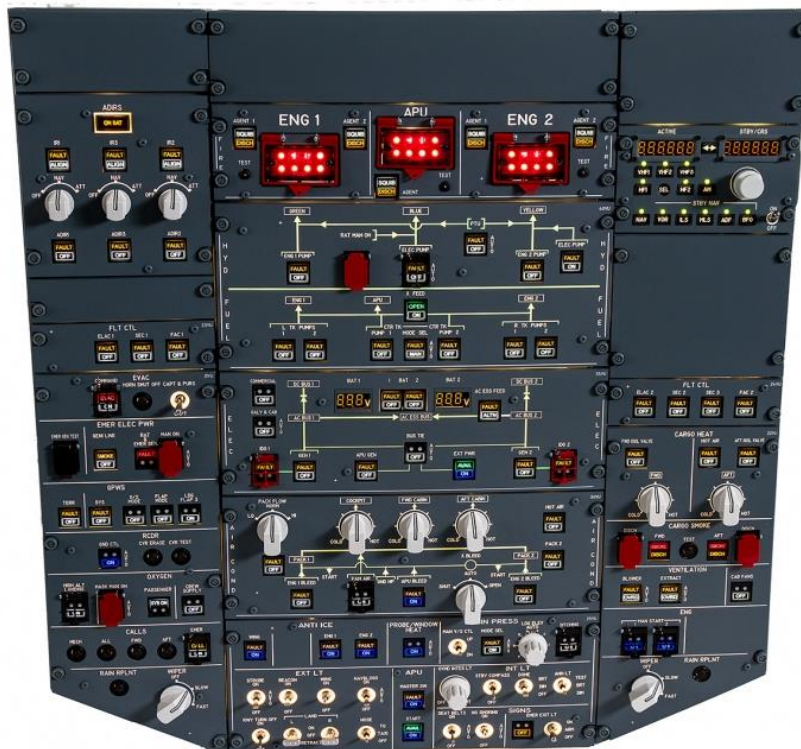
Figura 5.19 – Overhead Panel Completo del velivolo A-320
