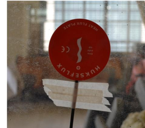
2. Il termoflussimetro è stato fissato al centro della lastra vetrata, lontano dalla superficie del telaio, tramite del nastro di carta, avendo cura di non coprire la zona più sensibile al centro. Per favorire l'aderenza alla superficie, è stata spalmata della pasta termica sul lato blu del sensore.
