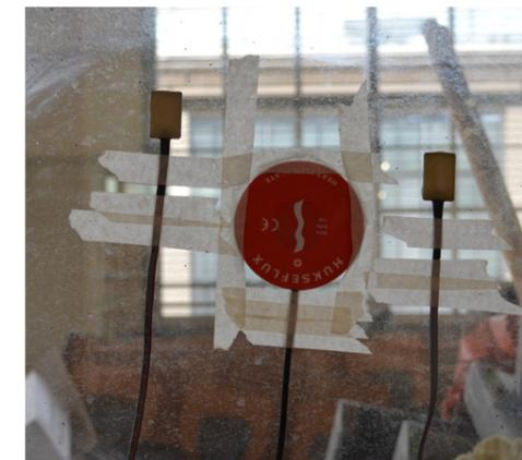
3. A poca distanza dal termoflussimetro sono stati posizionati i due sensori di temperatura a contatto, sempre con l'impiego di pasta termica e nastro adesivo di carta.
