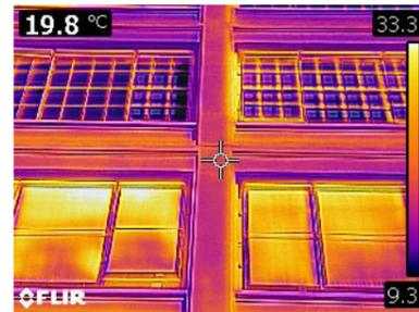
15. La superficie del sistema delle schermature solari è caratterizzata da una tonalità calda, facendo dunque supporre che poco protegge la struttura dall'accumulo delle radiazioni.
