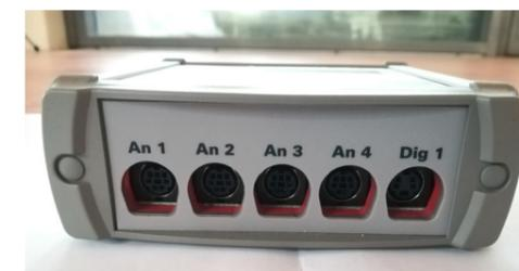
4. Posizionate le sonde, sono stati collegati i rispettivi cavi all'acquisitore-dati da sinistra verso destra nel seguente ordine: An1. termoflussimetro; An2. sonda di temperatura a contatto; An3. sonda di temperatura a contatto; An4. sonda di temperatura dell'aria.
