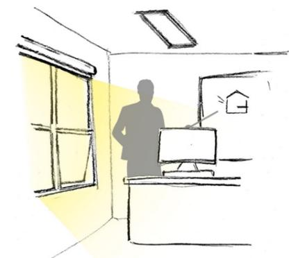
Fig. 78: Nonostante la presenza di utenti, l'impianto di illuminazione resta spento grazie all'installazione di sensori di intensità di luce che rilevano una sufficiente disponibilità di luce naturale per consentire il regolare svolgimento del compito visivo.
