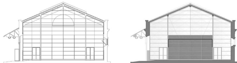
Figg. 24-25: Prospetto laterale e Sezione trasversale di uno dei padiglioni in seguito all'intervento di riqualificazione.
