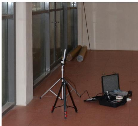
1. Per prima cosa è stata montata la sonda di temperatura dell'aria su un cavalletto di sostegno.
