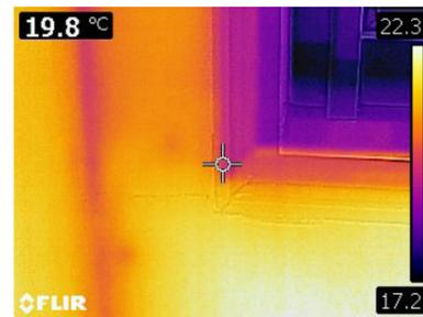
16. Individuazione dei ponti termici in corrispondenza del punto di giunzione tra il telaio del serramento ed il muro, e dell'angolo tra il pilastro e la parete di tamponamento.
