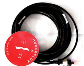
Esempio modello di termoflussimetro a piastra LSI LASTEM.
