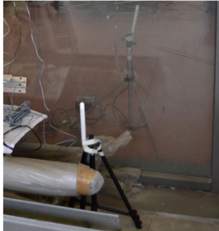
5. In corrispondenza del punto di misura interno, la sonda di temperatura esterna è stata installata sul cavalletto di sostegno e avvicinata al serramento.
