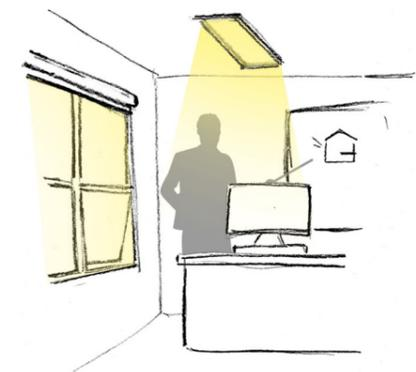
Fig. 77: Accensione dell'impianto di illuminazione artificiale grazie ai sensori di occupazione che rilevano la presenza di utenti nei locali.
