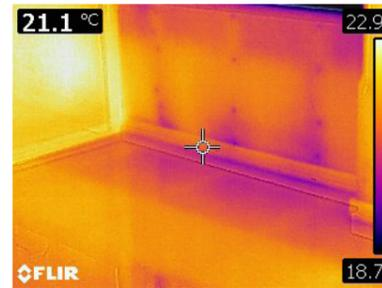
9. Individuazione del ponte termico tra partizione orizzontale e chiusura verticale. Il termogramma, inoltre, mostra in falsi colori l'anima della controparete che costituisce l'esito di un intervento successivo di isolamento delle pareti perimetrali esterne.
