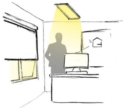
Fig. 79: Durante le ore di elevato irraggiamento solare, per evitare l'abbagliamento, le schermature vengono abbassate, non consentendo più la stessa disponibilità di luce naturale e pertanto l'impianto di illuminazione artificiale resta acceso.
