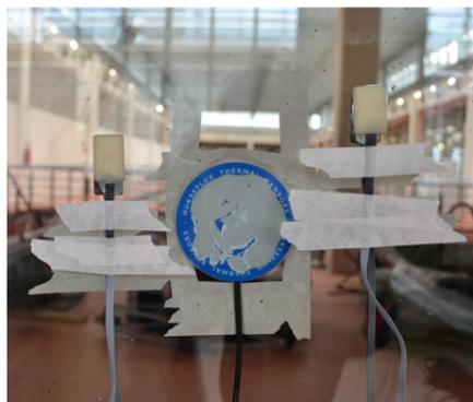
6. I due sensori di temperatura a contatto sono stati posizionati sul lato esterno il più possibile in corrispondenza dei due sensori interni. Si è poi proceduto al collegamento dei cavi al *datalogger* esterno con la stessa modalità adottata per i cavi dei sensori interni.
