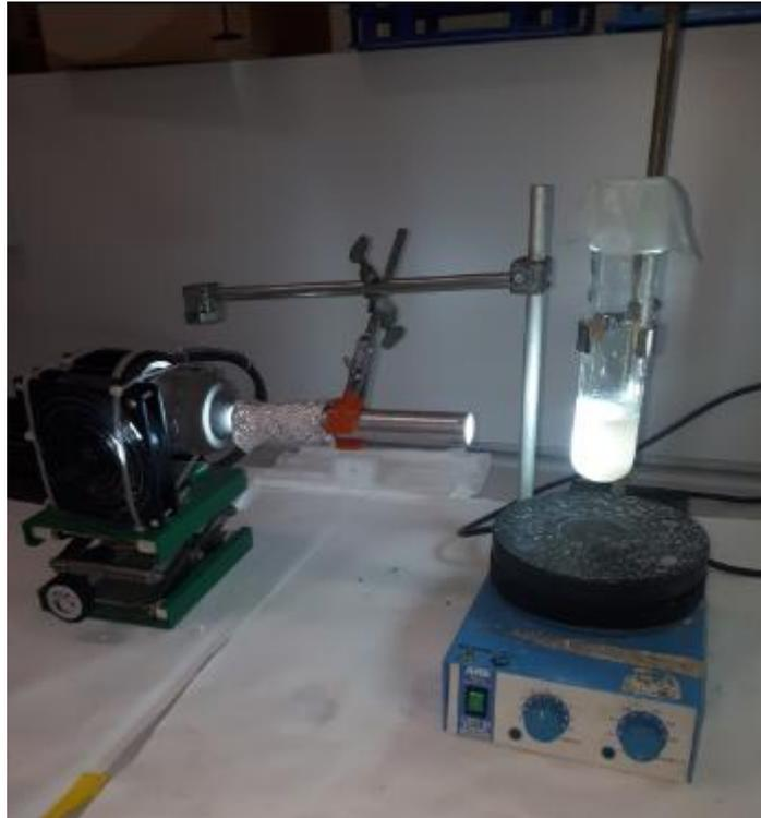
**Figura 27 Lampada solare e reattore**
