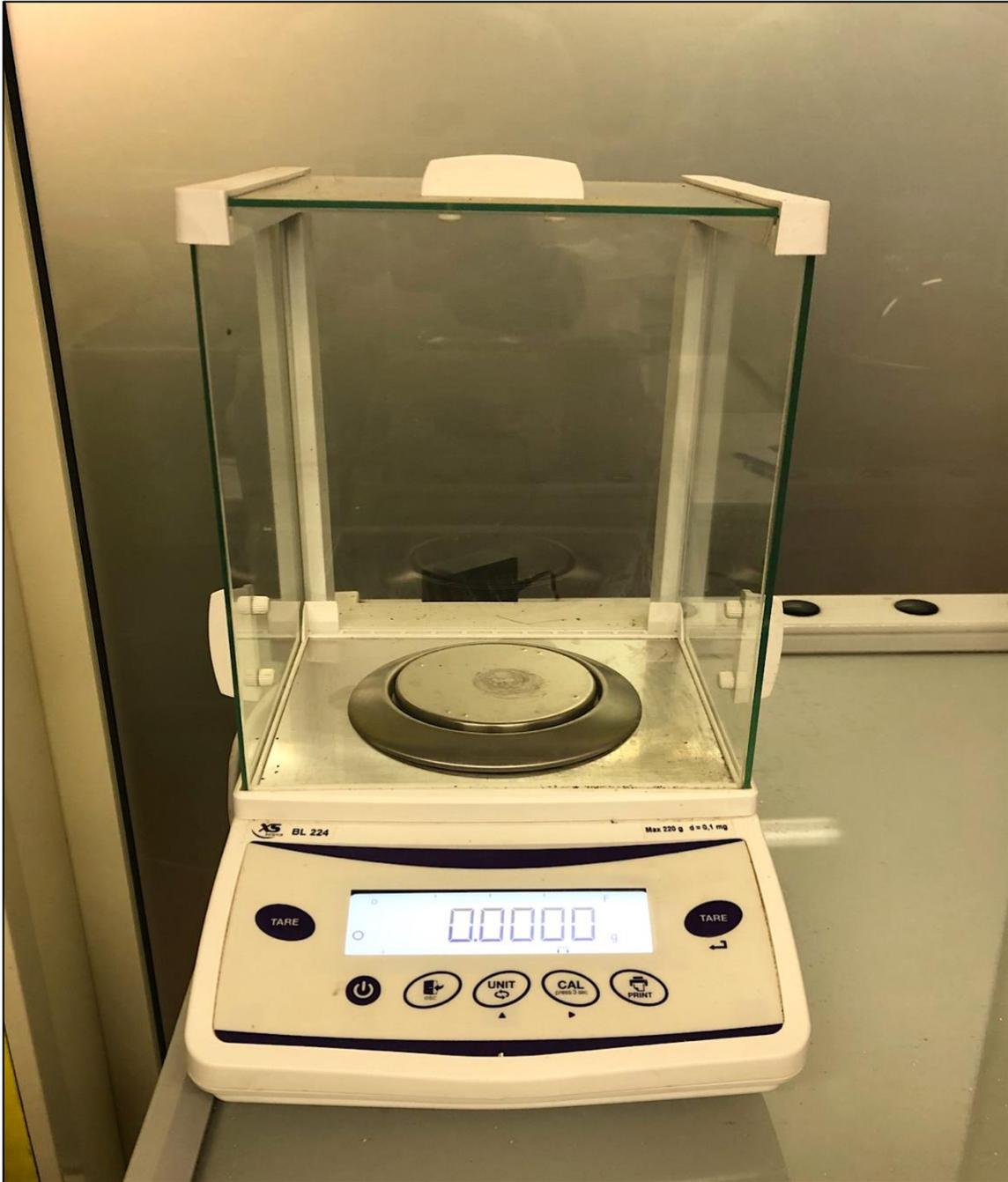
*Figura 7.3: Bilancia analitica KERN fornita dal Politecnico di Torino per effettuare le pesature*
