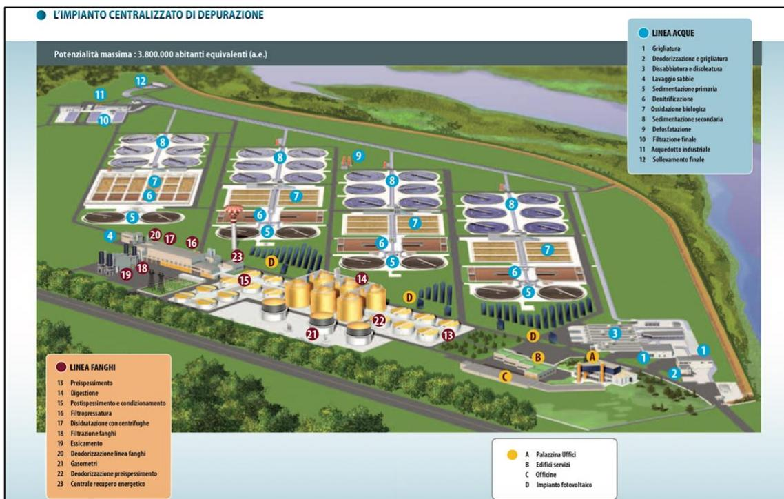
Figura 2.2: Schema generale dell'impianto centralizzato di depurazione delle acque reflue di Castiglione Torinese ("smatorino")
