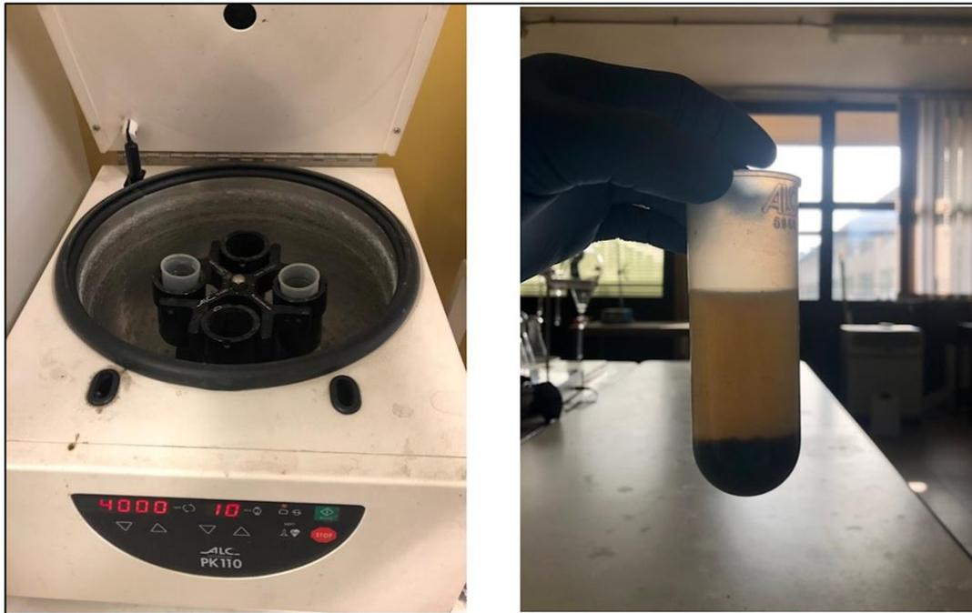
Figura 7.7: Centrifuga ALC PK110 fornita dal Politecnico di Torino e campione di fango post-centrifugazione
