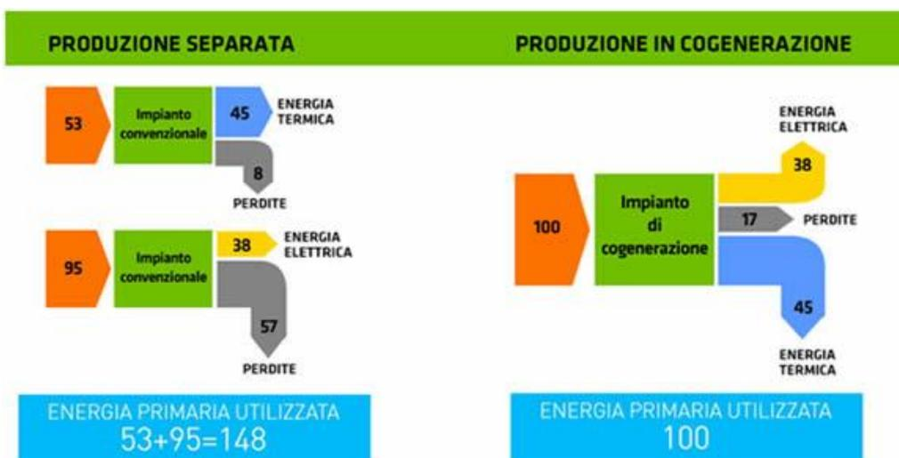
Figura 16: Differenza tra produzione separata e produzione in cogenerazione [43]
