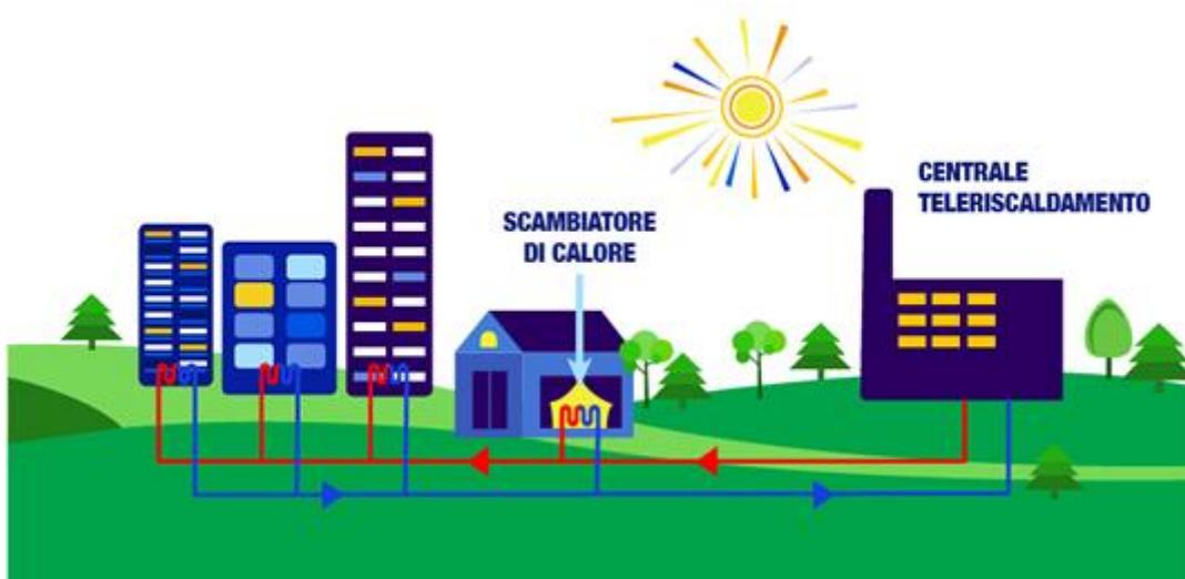
Figura 11: Schematizzazione generale di un sistema di teleriscaldamento [1]
