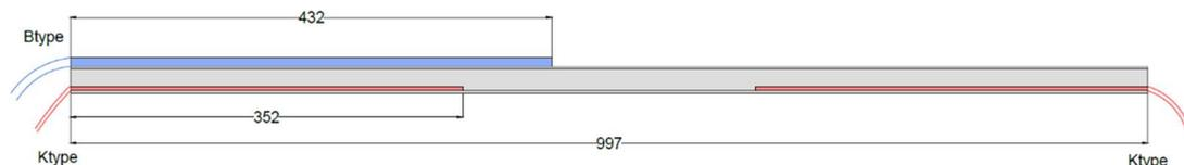
Figura 4.7. Vista in sezione del ricevitore cilindrico con le due termocoppie: B-type (in blu, termocoppia ambientale) e K-type (in rosso). Le quote riportate sono in [mm].
