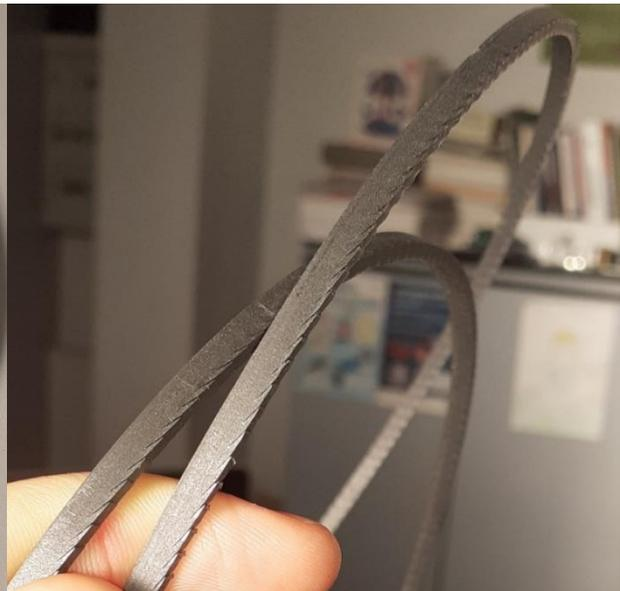
**FIGURE 5.3 NOTCHES IN THE GASKET**
