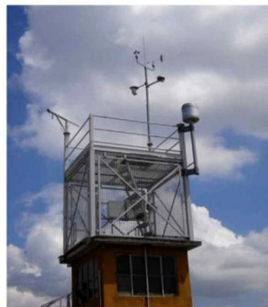
figura 11 – fotografia della centralina climatica
