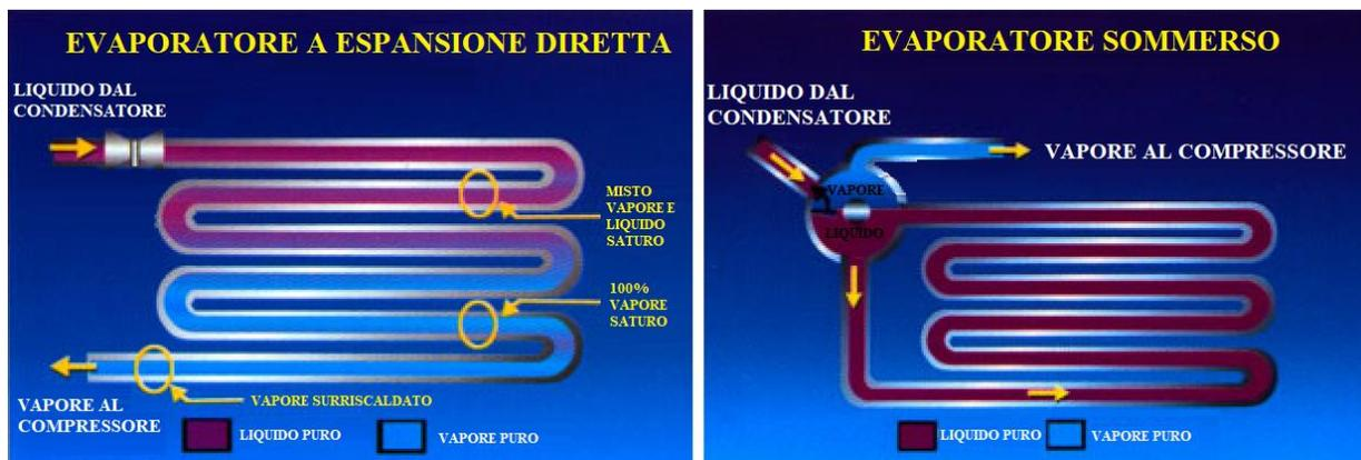
Figura 3.8. Schema evaporatore ad espansione diretta (sinistra) e sommerso (destra) [20].
