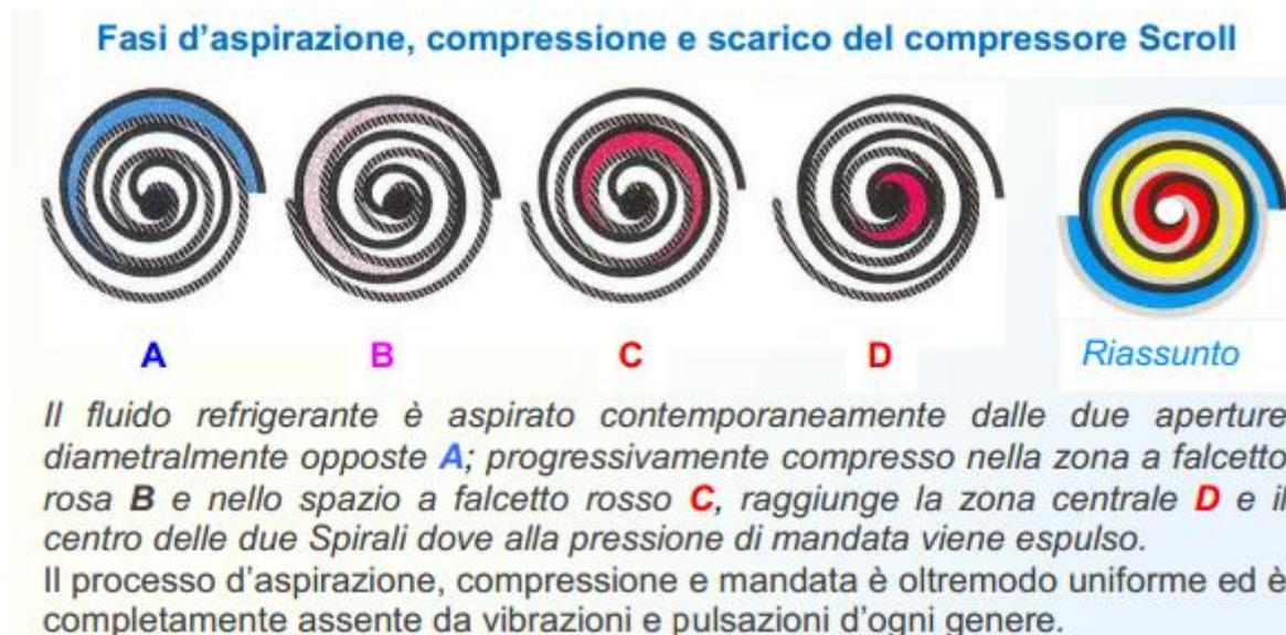
**Figura 3.5.** Schema funzionamento compressore a spirale [17].
