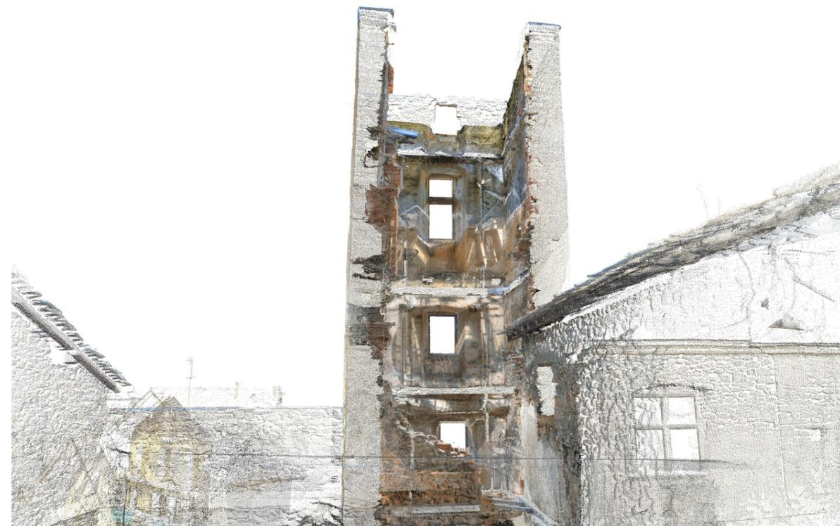
Fig.7 Vista nuvola di punti inquadrata da dentro il corpo centrale ruderizzato.
