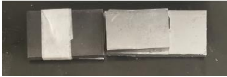
Fig.3.27. Foto degli spessori metallici utilizzati per le prove di trazione dell'intero modello
