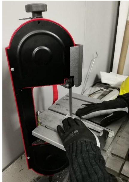
Fig. 3.22. Taglio dei provini con l'ausilio di una sega a nastro
