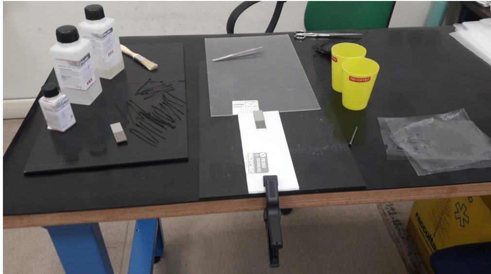
Fig. 3.13. Materiale utilizzato per realizzare le giunzioni
