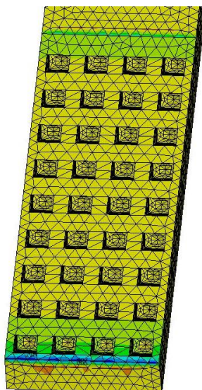
Fig.2.45. Schermata della distribuzione dello sforzo di taglio sul composito del modello con parallelepipedi inclinati verso l'alto
