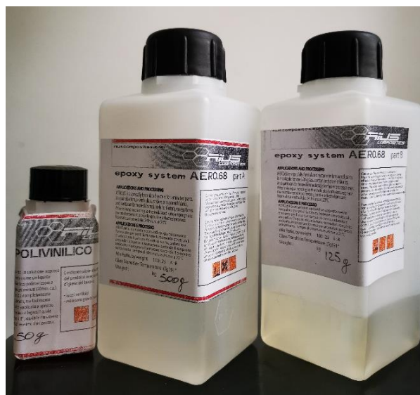
Fig. 3.11. Sistema epossidico parte A e parte B da miscelare per formare la resina e distaccante polivinilico che permette di staccare la resina dal piano di lavoro
