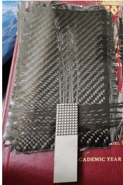
Fig. 3.18. Provino asciutto rimosso dai supporti in plastica
