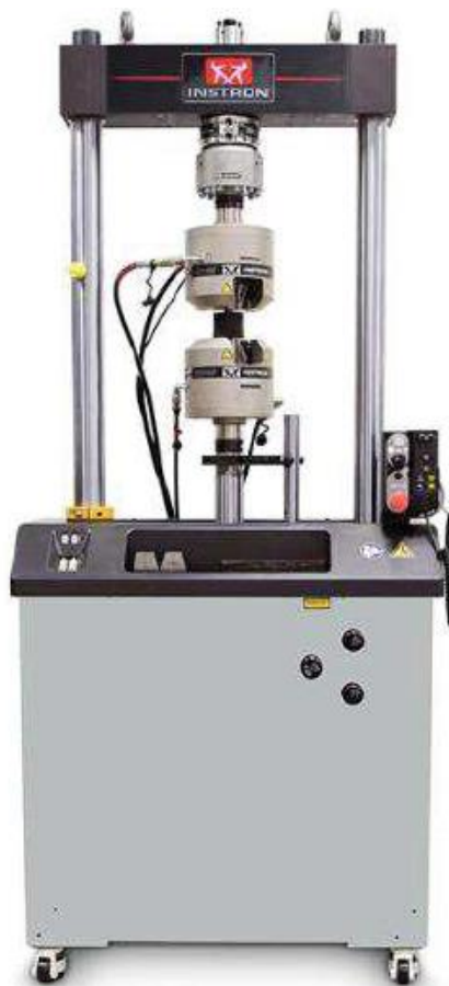
Fig. 3.21. Macchina a trazione utilizzata per le prove sperimentali in laboratorio
