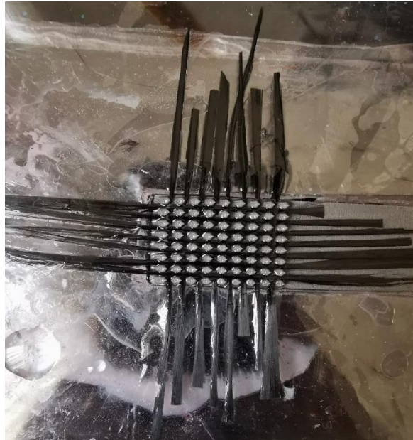
Fig. 3.14. Inserimento singole fibre manualmente impregnate di resina tra le punte
