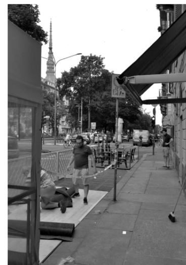
La qualità dei marciapiedi così come quella delle banchine di sosta dei pullman non è adeguata sotto diversi punti di vista. La dimensione per il passaggio è ridotta al minimo, lo spazio è angusto, la superficie è disconnessa e dissestata e come spesso accade i rattoppi vengono eseguiti con materiali differenti e con poca cura, riconsegnando uno spazio che esteticamente peggiorato
