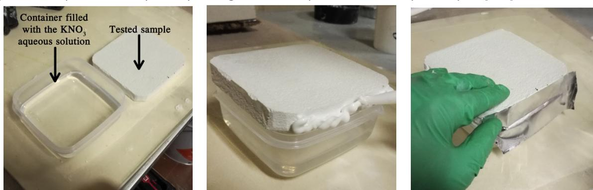
Come primo passaggio il campione viene tagliato e sigillato da un lato in un contenitore; è necessario prestare molta attenzione poiché deve essere perfettamente tappato per evitare che l'acqua evapori da altri punti e non solo attraverso il provino. Il recipiente è infatti riempito con una soluzione acquosa: usiamo il nitrato di potassio, dosato e accuratamente miscelato con acqua, per rendere saturo l'intercapedine d'aria all'interno della vaschetta che arriva così ad una
