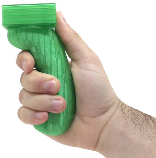
FIG.33: Primi test sull'ergonomia dell'impugnatura con modello stampato in 3D
