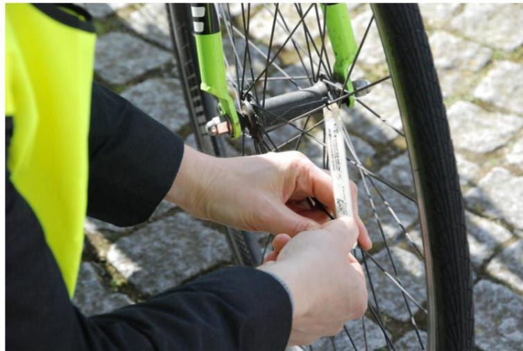
Fig. 2.23. RFID tags installation
