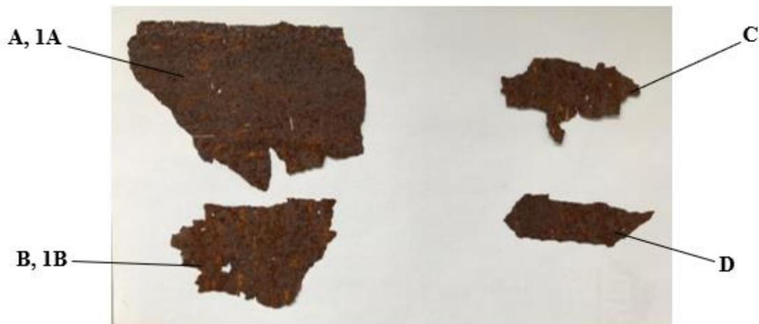
**Figura 6.1** Campioni prelevati da una lastra per le analisi chimiche e microstrutturali.
