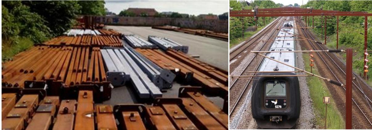
**Figura 3.2** A sinistra deposito di pali da elettrificazione ad uso ferroviario, notare come siano presenti sia elementi in CorTen che in acciaio zincati. A destra pali da elettrificazione in acciaio Corten durante l'utilizzo. Notare come non si tratti di una stazione, tratte da [16].
