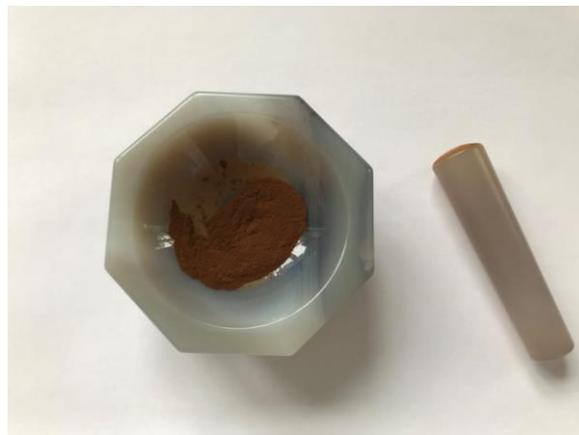
**Figura 6.2** Mortaio utilizzato per la l'ottenimento delle polveri.
