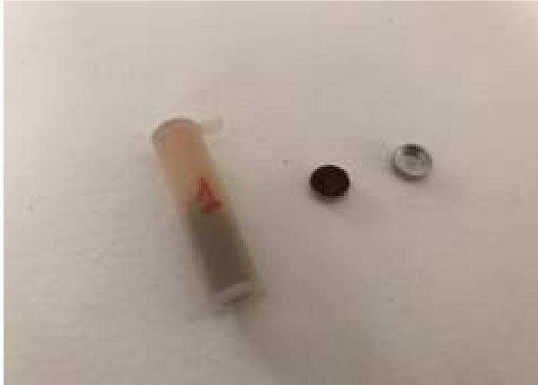
**Figura 6.8** *Contenitore per il campione A di polveri e cilindro in cui sono state inserite le polveri per analizzarle con lo spettrometro i-Raman Plus.*
