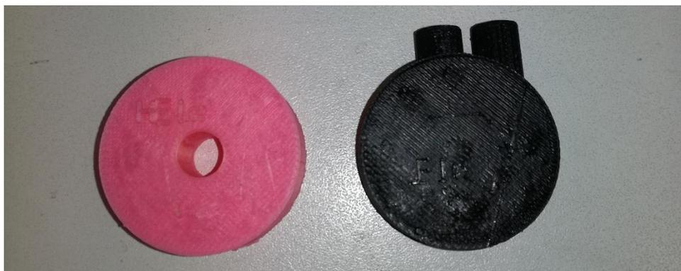
**Figura 5.5** Celle di misura realizzata in ABS mediante l'utilizzo della stampante 3D, a sinistra la cella rosa progettata su superfici piane, a destra quella progettata per pareti verticali.
