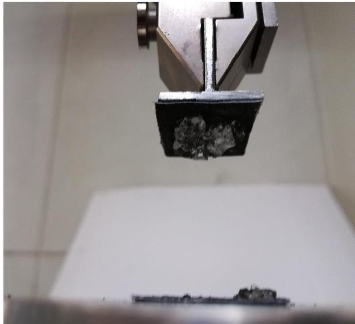
**FIGURE 60. NEAT M-CMC HYDROGEL AT FAILURE**
