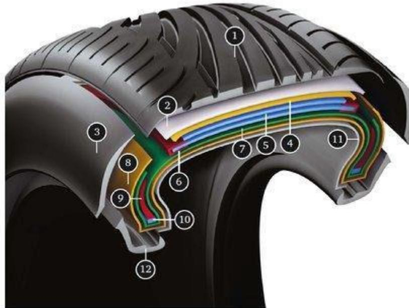
**Figura 1.3** 1) Battistrada, 2) Base battistrada, 3) fianco, 4) rete in nylon, 5) cinture, 6) anello copri-cintura, 7) carcassa-strato 2, 8) carcassa-strato 1, 9) striscia di riempimento tallone, 10) tallone, 11) rivestimento interno, 12) anello di bordo in gomma. (estratta da Apollo Vredestein tyres).
