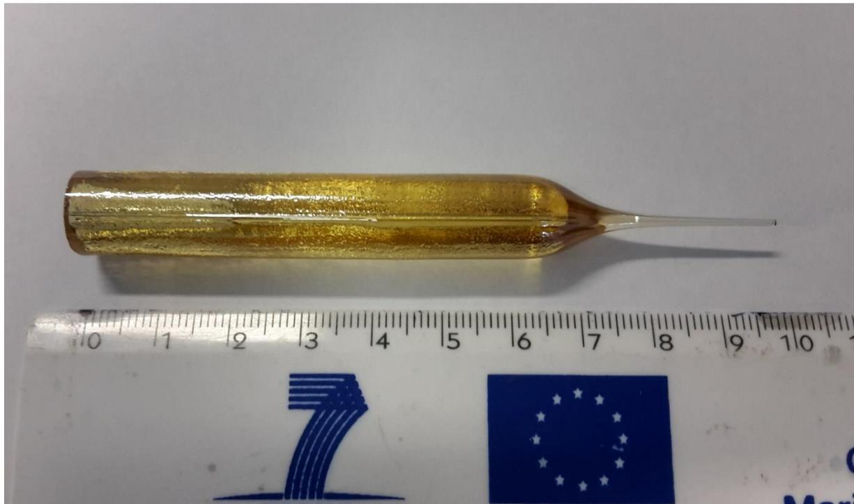
**Fig. 1** *Preforma in vetro a base tellurite prodotta dal Dipartimento di Scienza Applicata e Tecnologia (DISAT).*
