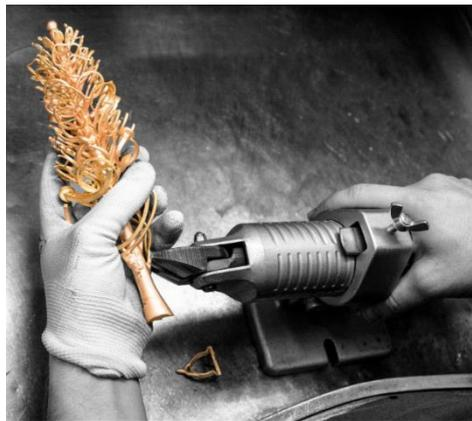
*Figura 31: Operazione di spiantonatura dell'albero in lega<sup>10</sup>*
