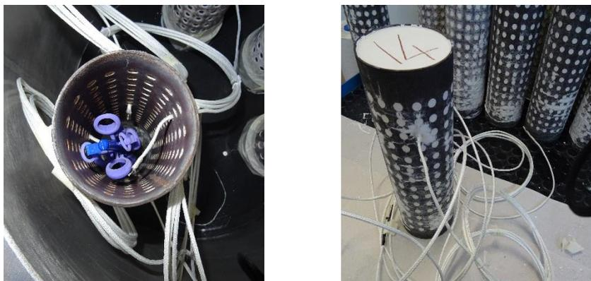
*Figura 42: Disposizione termocoppie all'interno del cilindro*
