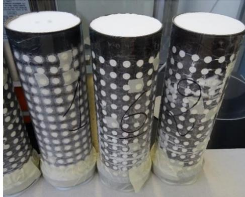
Figura 9: Cilindri riempiti con miscela gesso-silice.
