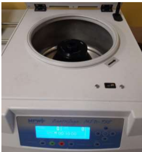
Figura 5.6: Centrifuga MPW-352 utilizzata per la preparazione dei campioni destinati alla filtrazione
