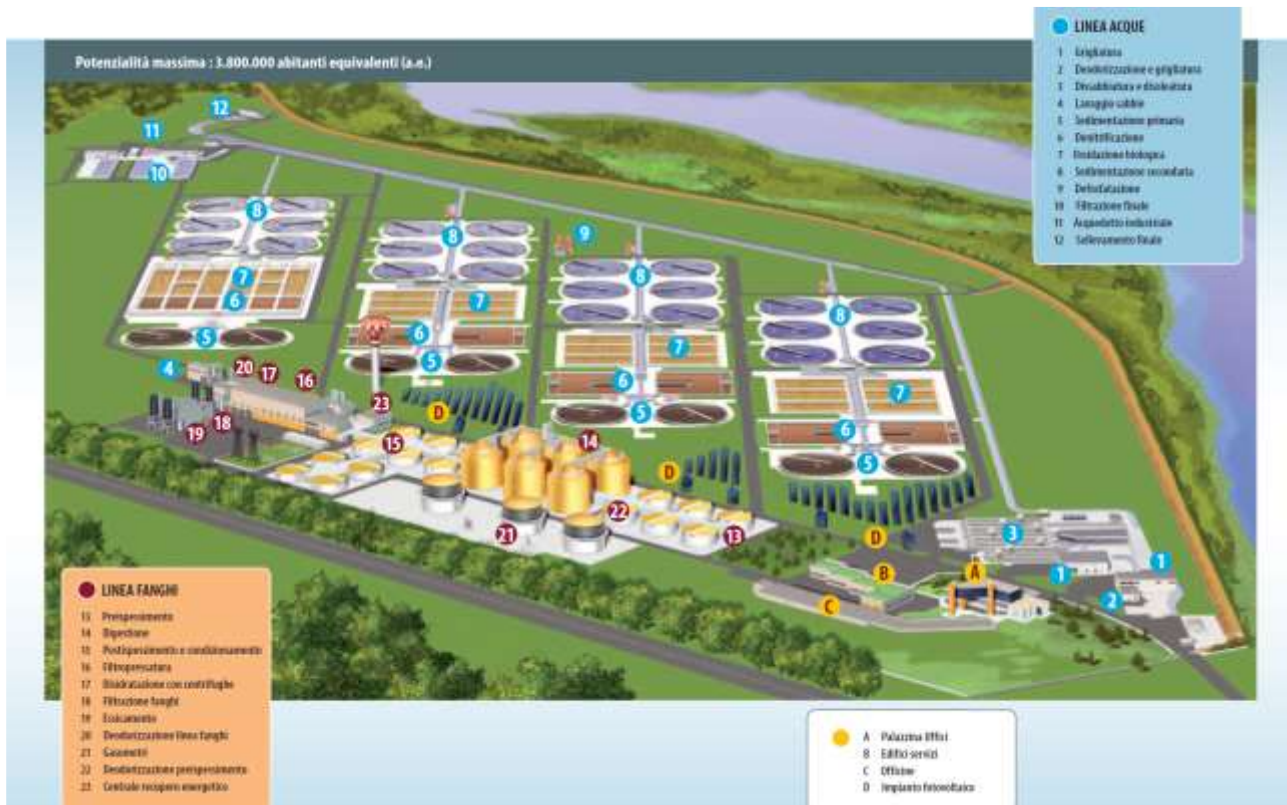
Figura 2.1: Pianta dell'impianto SMAT di Castiglione Torinese
