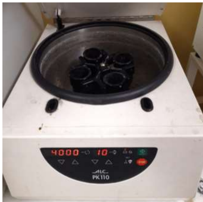
Figura 5 4: Centrifuga ALC PK 110 usata per la preparazione del fango alla titolazione
