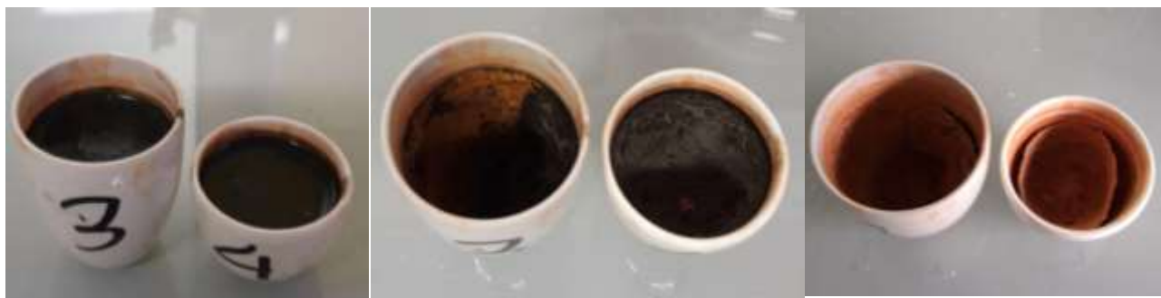
Figura 5.3: Una coppia di crogioli contenenti, in ordine da sinistra a destra, lo stesso campione di fango I stadio fresco, subito dopo l'essiccamento e infine dopo la muffola.
