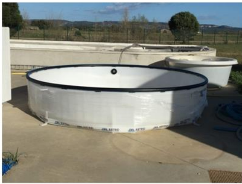
Figura 3.14: Vasca secondaria che simula un raceway classico: foto (a), sezione della vasca secondaria con misure in millimetri (b)
