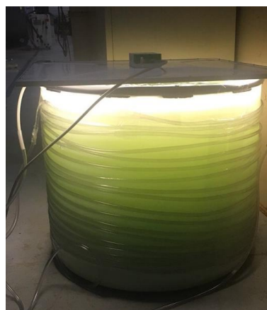
Figura 3.6: Sistema di riscaldamento del PBR
