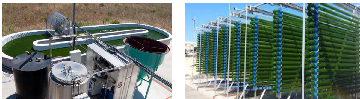
Figura 1.6: Esempi di fotobioreattori aperti (Raceway INRAE - LBE) e chiusi (PBR tubolari)
