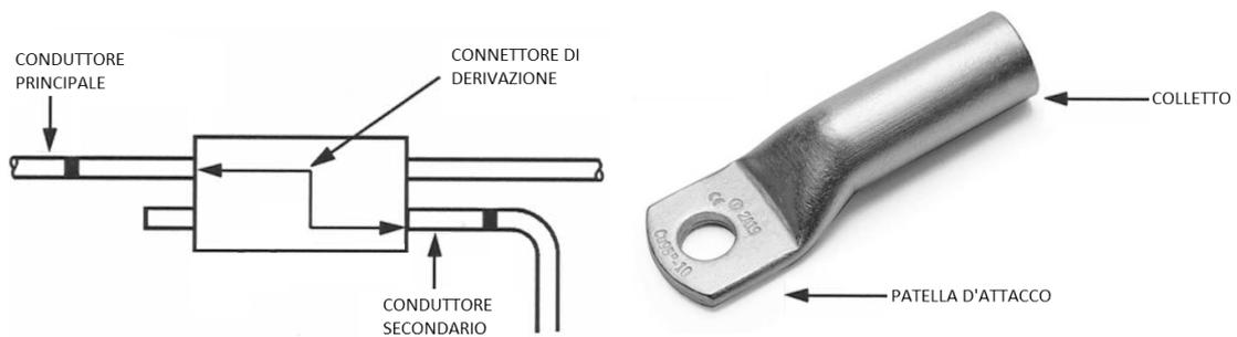
Figura 3.8: A sinistra la schematizzazione di un connettore di derivazione, tratta dalla norma CEI EN 61328-1; a destra un capocorda di Rame con connessione per compressione
