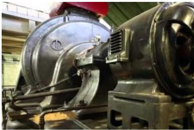
Figura 2.2: Alternatore trifase *S.A. Brown Boveri* con motore asincrono trifase di lancio, nel piano seminterrato del laboratorio LATFC.
