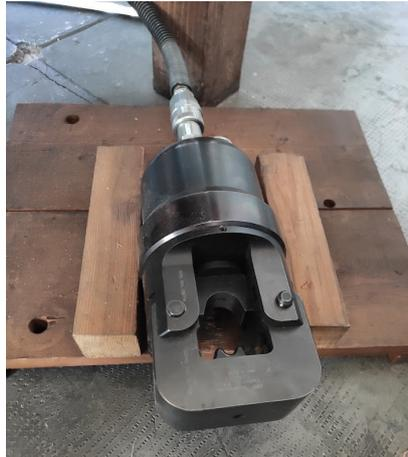
Figura 3.9: Utensile crimpatore pneumatico utilizzato nel LATFC per cavi fino a  $240 \text{ mm}^2$
