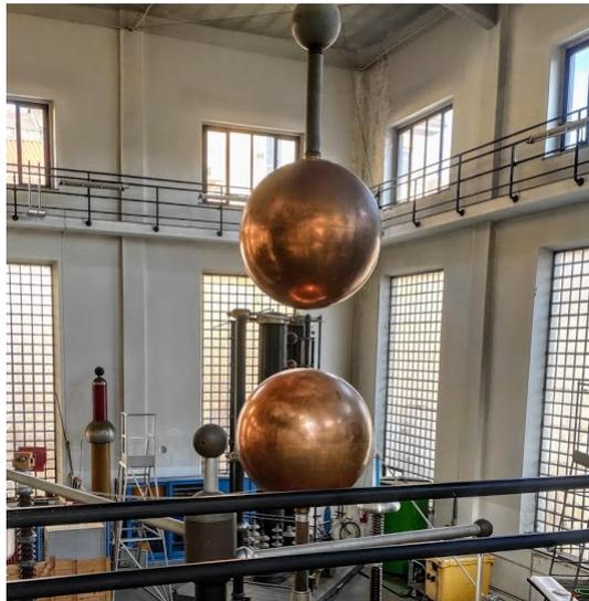
Figura 2.1: Spinterometro a sfere isolate in aria, presente nell'area Alte Tensioni del laboratorio, per la misura diretta del valore di picco di tensione
