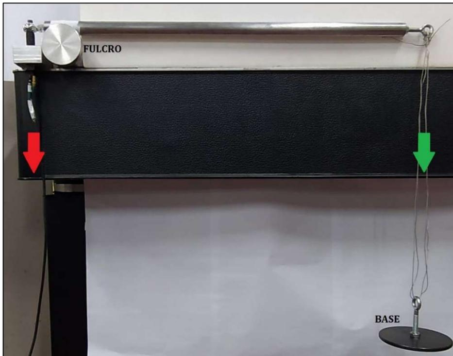
Figura 130: Banco di prova per prova statica a trazione pura
