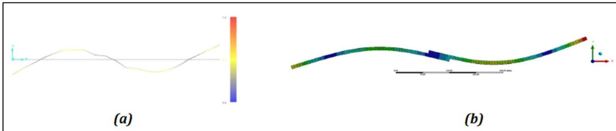
Figura 91: Seconda forma modale (a) dell'esperimento e (b) del modello FEA
