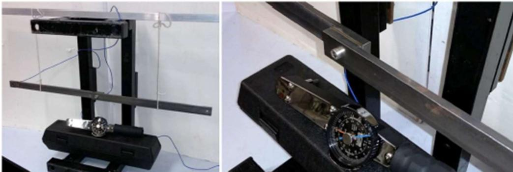
Figura 84: Banco di prova assemblato con chiave dinamometrica
