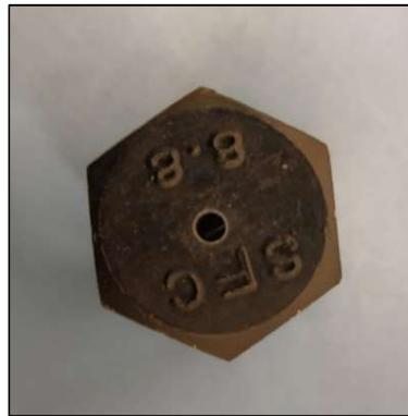
Figura 117: Foro sulla testa della vite (B12) da cui passano i collegamenti elettrici
