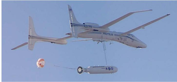
Figura 2.5. Dettaglio del sistema t/LAD, con il trapezio, la corda e il paracadute stabilizzatore [33]
