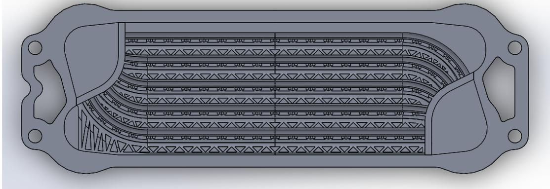
Figura 3.23: Vista in pianta dello scambiatore finale aperto
