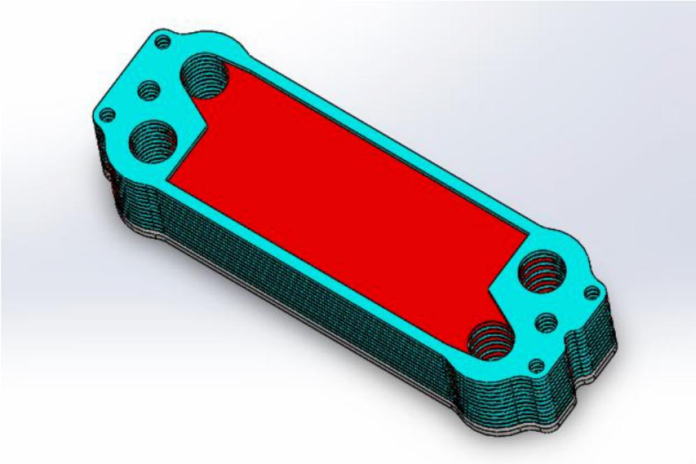
Figura 1.17: Vista del canale di scorrimento del fluido con scambiatore assemblato
