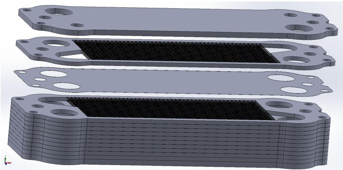
Figura 3.11: Vista esplosa dello scambiatore
