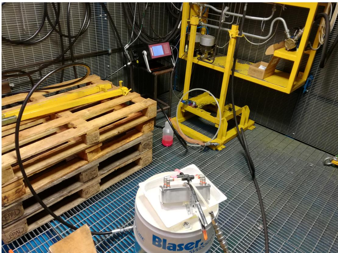
Figura 4.11: Scambiatore connesso ai tubi per la prova di flussaggio
