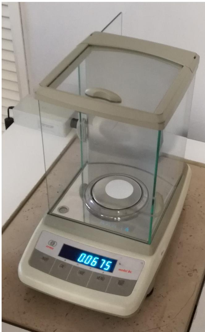
Figura 4.13: Peso del filtro utilizzato per il calcolo del residuo secco
