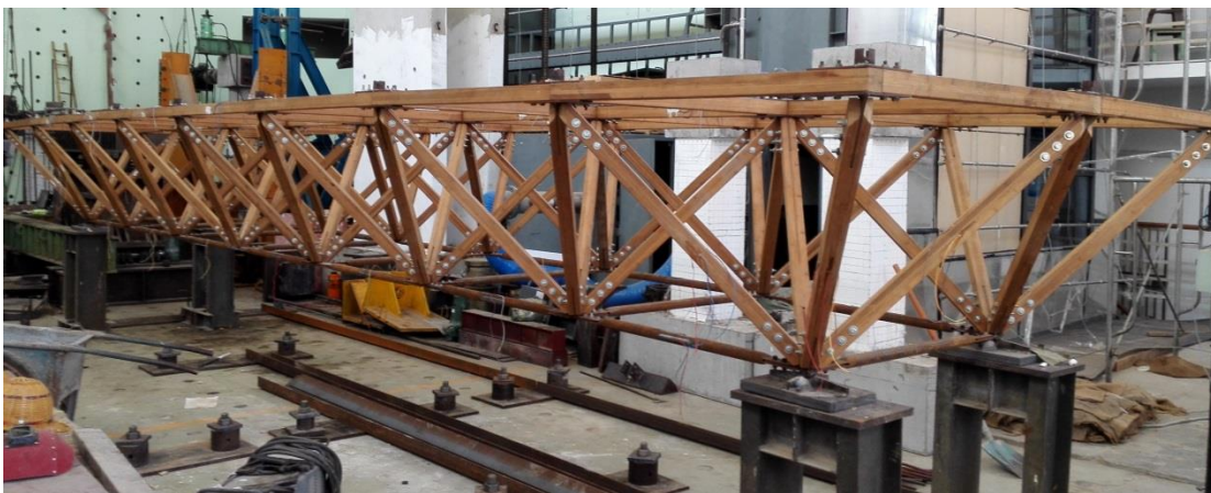
Figura 51 Prototipo della struttura reticolare ibrida in acciaio e glubam. Nanjing Tech University (Cina)
