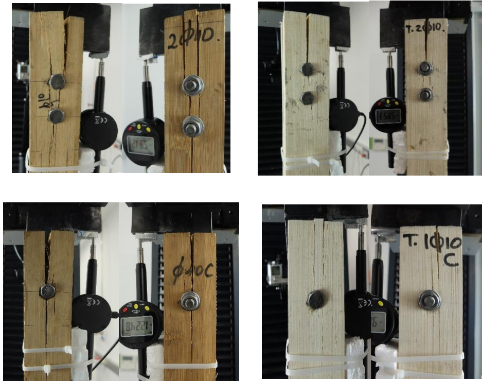
Figura 81 Fenomeni di rottura di alcuni campioni sperimentati. A sinistra i provini in glubam, a destra quelli in legno lamellare.
