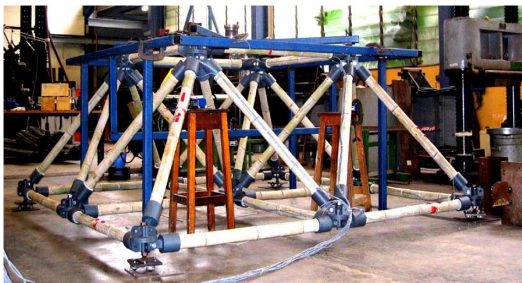
Figura 49 Sistema reticolare in bambù con giunti in PVC. (47)
