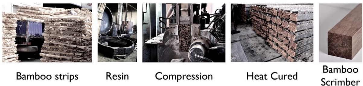
Figura 36 Bamboo composito, processo di lavorazione in China (28).
