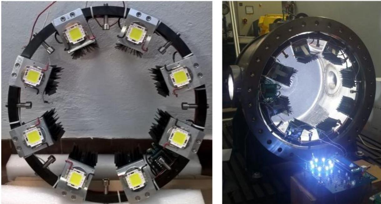
*Figura 23: sistema di illuminazione ad anello LED*
