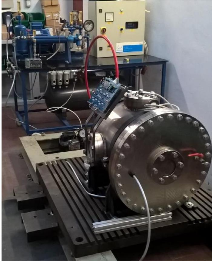
*Figura 27: camera di iniezione*
