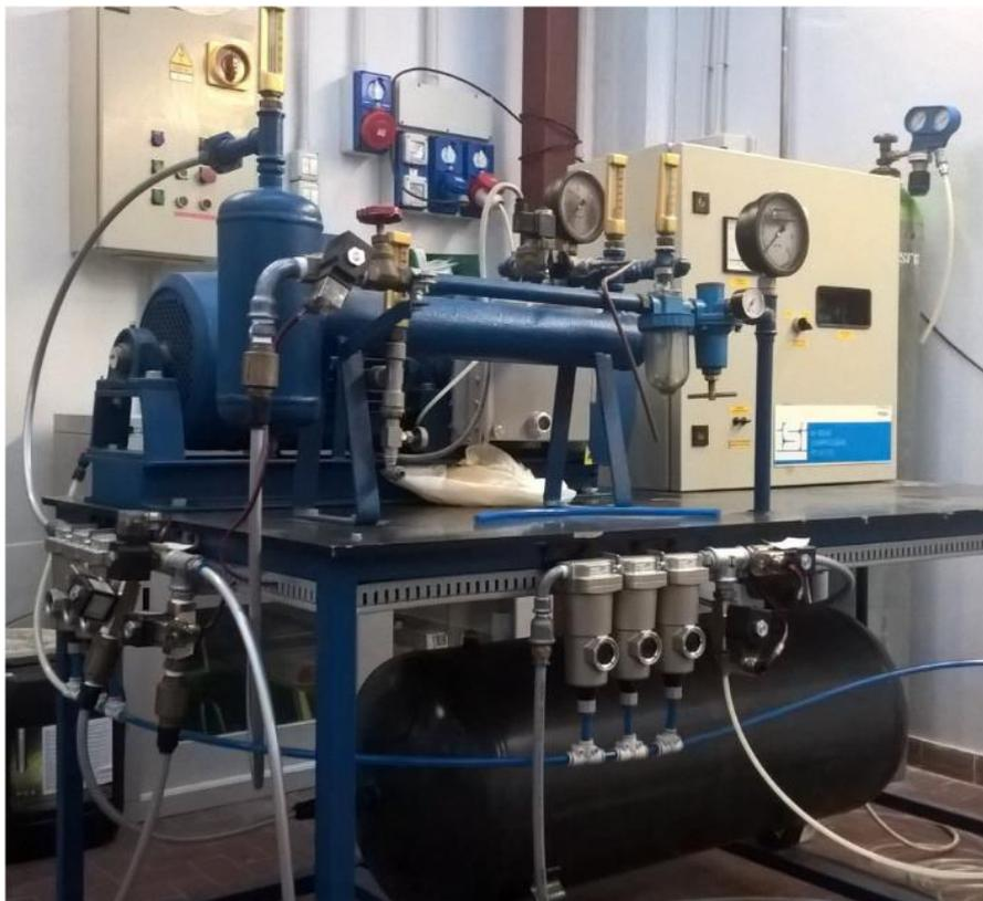
*Figura 28: sistema di ricircolo e stoccaggio del gas*
