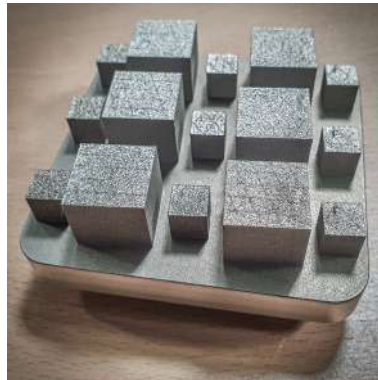
Figura 24: Provini di IN939 su base di crescita (dimensioni 90x90 mm)
