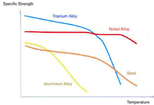
Figura 9: Resistenza specifica in funzione della temperatura per diversi metalli [30]
