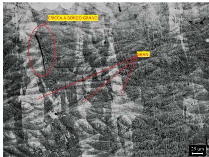
Figura 38: Campione as-built: micrografia piano ZX
