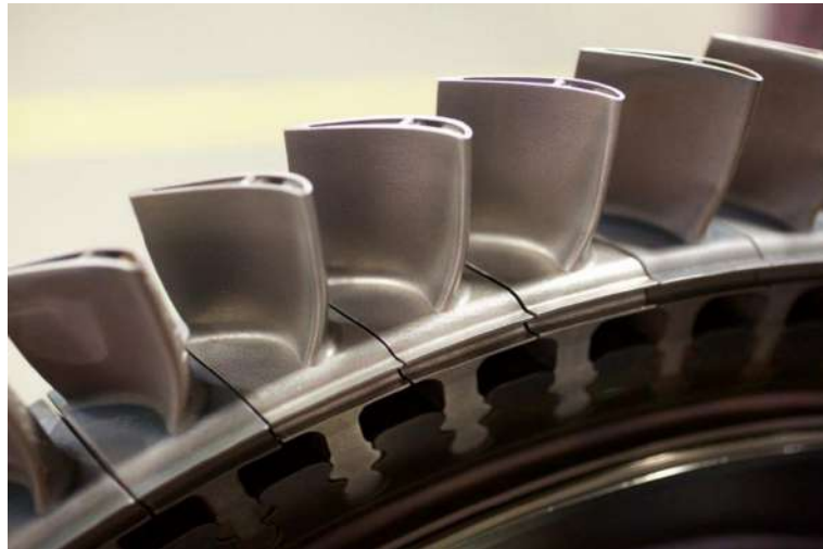
Figura 7: Schiera di palette alloggiate in disco di turbina [19]
