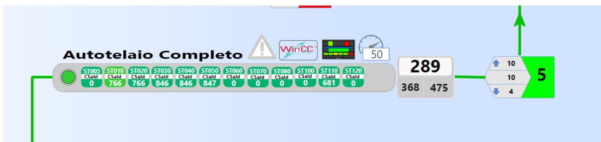
Figura 34: Sinottico della linea dell'autotelaio completo con le relative stazioni
