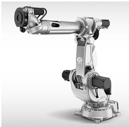
Figura 48: Robot COMAU SMART5 NJ4 175-2.2-I
