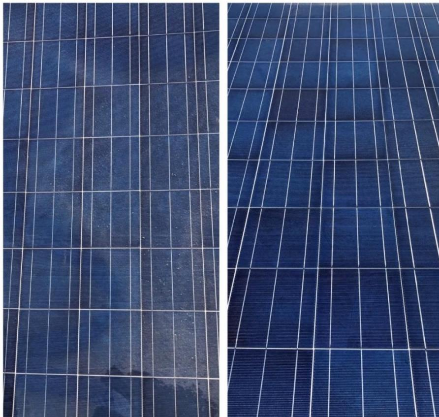
*Figura 20: Confronto dello stesso modulo prima e dopo averlo pulito*
