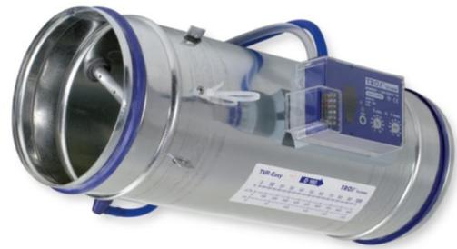
Nel momento in cui la sonda rileva una variazione del valore differenziale di pressione rispetto a quello di set-point, comunica alla VAV la necessità di aprire/chudere la serranda. In questo modo viene sempre garantito il  $\Delta P$  imposto. Le VAV presenti sono state dimensionate in modo tale che la portata di progetto sia circa il 50% della del campo di regolazione della VAV. Questo perché attorno a quel valore si ha un migliore e più accurato controllo della portata.
