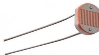
vengono rilevate tramite due aree di materiale altamente conduttivo, applicate al di sopra del semiconduttore, e facenti capo a due terminali di output. Lo schema di funzionamento di una fotoresistenza generica è sintetizzato in figura 4.12.
