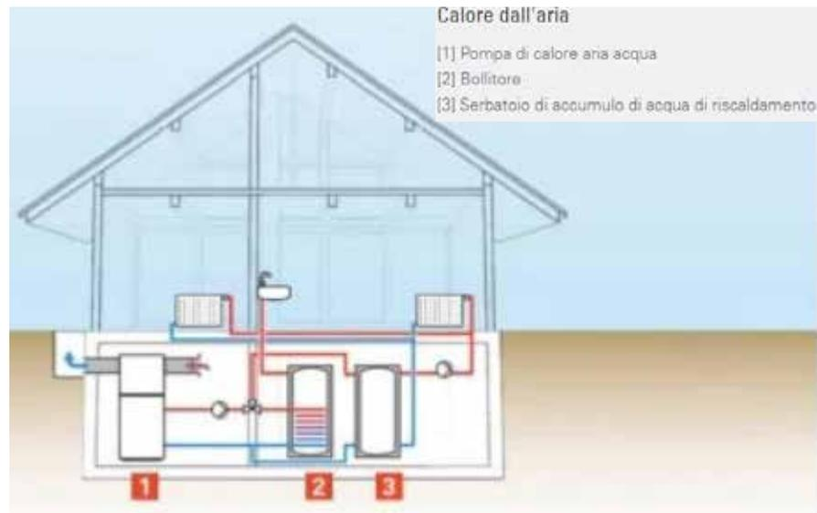
Figura 5.8 – Schema di funzionamento di una pompa di calore aria/acqua installata internamente
