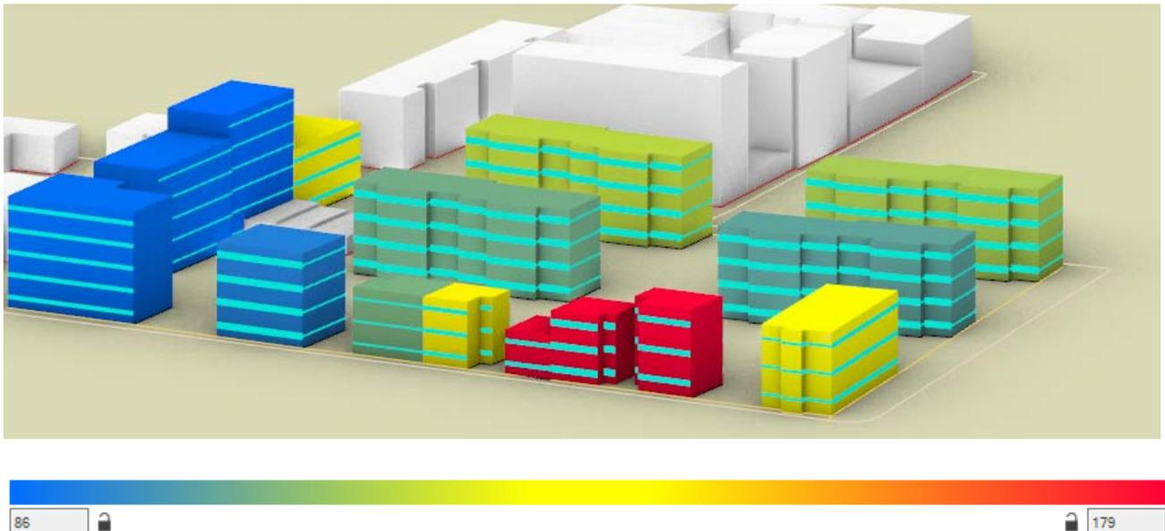
**Fig. 31** – Rappresentazione cromatica fabbisogno termico annuo in  $[kWh/m^2]$ , UMI.
