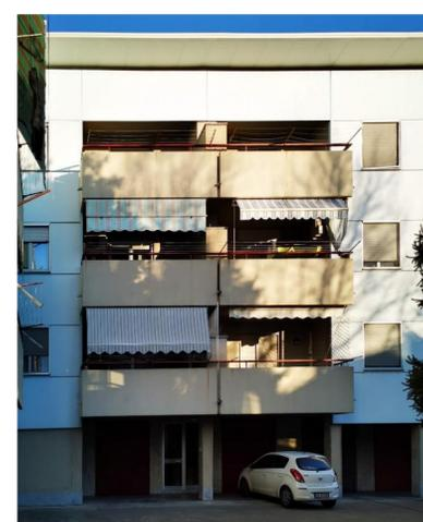
Il prospetto Nord-ovest affaccia sul cortile comune, e su tale facciata è collocato l'accesso principale al condominio. L'intero prospetto è rivestito da pannelli prefabbricati di colore bianco, che si interrompono esclusivamente a ridosso di balconi e del piano terra.
