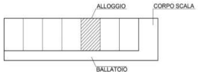
FIGURE 56: ESEMPIO DI DISTRIBUZIONE A BALLATOIO
