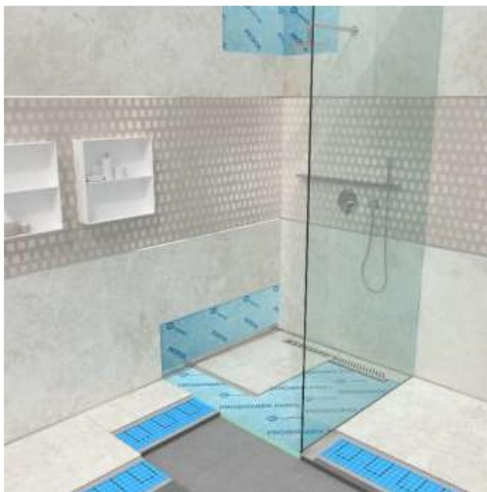
FIGURE 71: IMPERMEABILIZZAZIONE DOCCIA A PAVIMENTO
