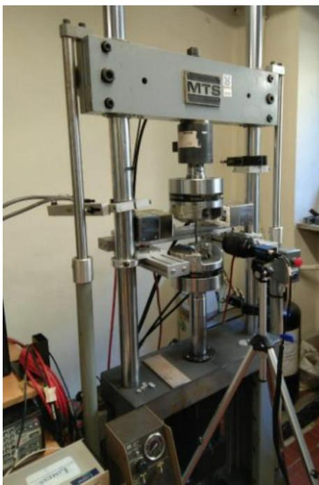
Figura 9: Configurazione del sensore fotografico per DIC nelle prove di trazione uniassiale.
