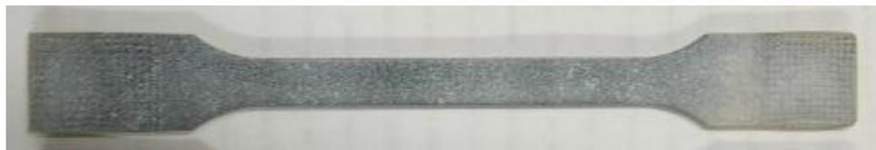
*Figura 27: Provino di polietilene utilizzato nella prova preliminare.*
