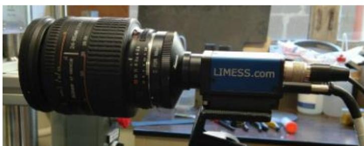
Figura 11: Sensore fotografico CCD e scheda d'acquisizione Limes.
