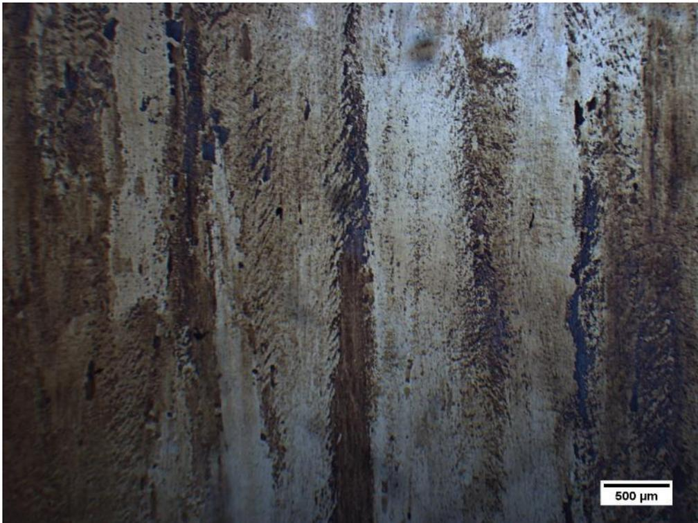
*Figura 111: Grani colonnari non ricristallizzati con larghezze prossime ai 500 $\mu$ m e lunghezze prossime ai 2mm.*
