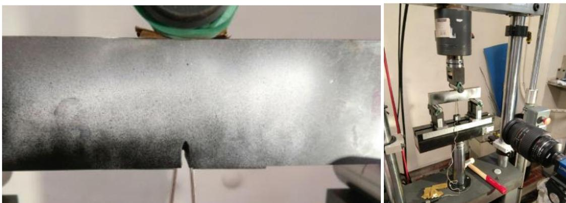
Figura 173: Configurazione attrezzatura per prove DIC.
