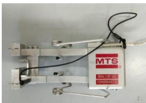
Figura 10: Estensimetro MTS per il calcolo delle deformazioni.
