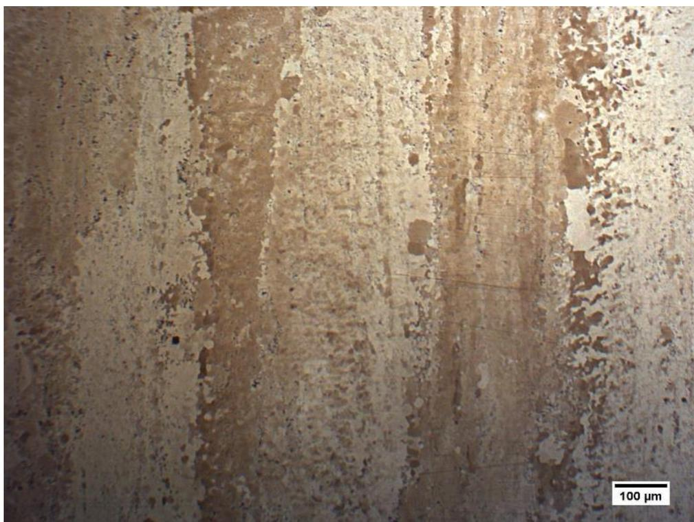
*Figura 118: Nell'immagine si vedono i grani primari colonnari non ricristallizzati e alcuni grani più piccoli, fini e ricristallizzati lungo in bordo di grano.*
