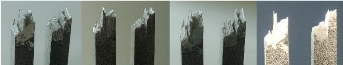
*Figura 45: Superficie di frattura del provino R61LT. Da notare come si sia creata la delaminazione, forse dovuta a decoesione dei cristalli lungo i bordi di grano ad alto angolo.*
