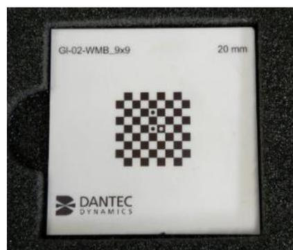
Figura 15: Calibratore con scacchiera 9x9 e quadrati da 2mm della Dantec Dynamics.
