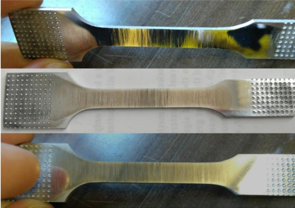
*Figura 121: In queste tre fotografie viene mostrata la superficie bandizzata del provino R6TS dopo aver subito la deformazione al 5%. Da diverse angolazioni è possibile vedere, anche a occhio nudo, le bande plastiche che sono emerse sulla superficie.*
