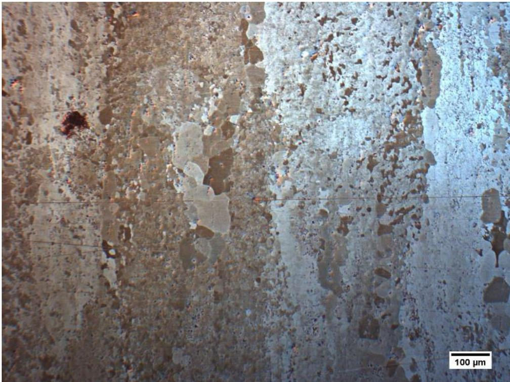
*Figura 119: Grani primari colonnari non ricristallizzati e grani più piccoli, fini e ricristallizzati che presentano una colorazione differente, per via del diverso orientamento cristallografico.*
