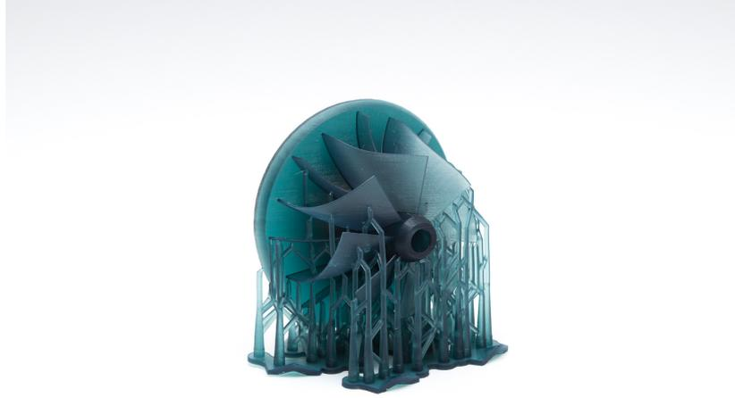
**Figura 5.3:** *Esempio di impiego del materiale di supporto*
