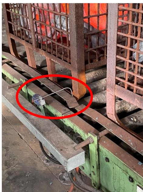
*Figura 69; esempio di sensore danneggiato*
