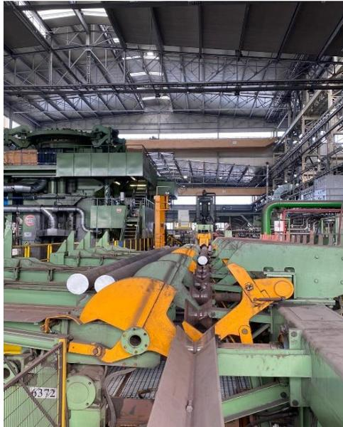
*Figura 27; impianto di caricamento barre*
