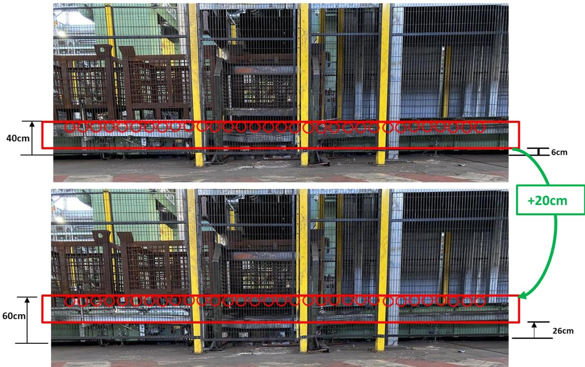
Figura 74; innalzamento della rulliera Trascar
