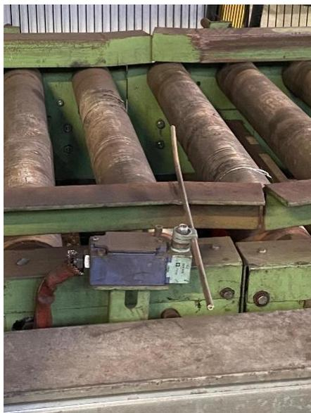
*Figura 68; sensore meccanico di fine corsa*
