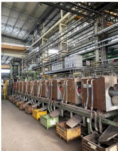
*Figura 28; bobine di riscaldamento*
