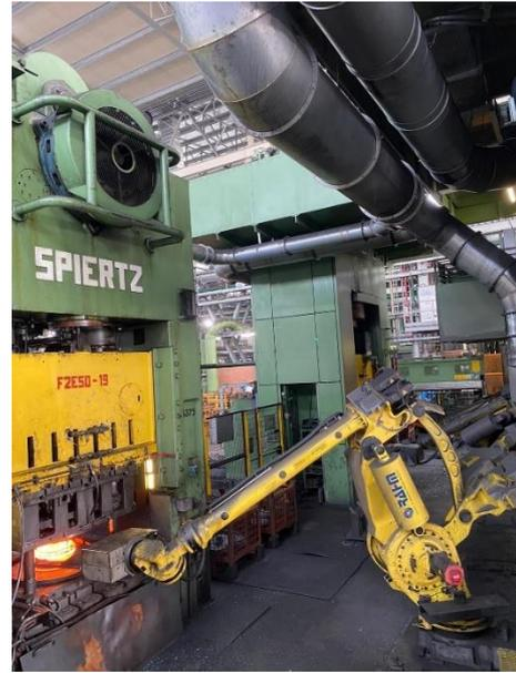
Figura 39; robot R3 in asservimento alla pressa sbavatrice Spiertz
