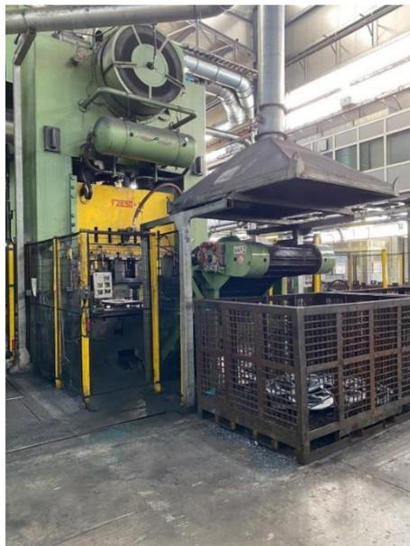
Figura 40; pressa sbavatrice Spiertz e nastro di evacuazione bave
