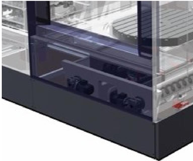
**Figura 5.7:** Dettaglio della carenatura del centro di lavoro *UMILL 1500*.
