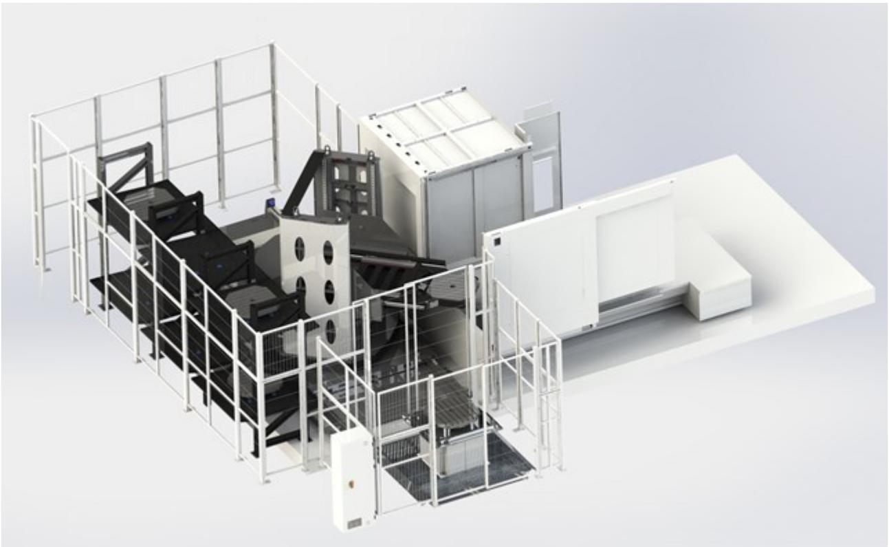
**Figura 5.5:** Applicazione del sistema *APC* con magazzino lineare a *UMILL 1500* (particolare di carenatura e basamento).
