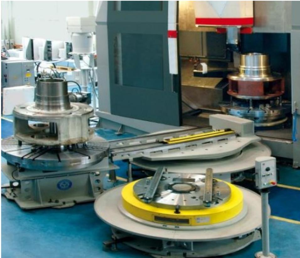
**Figura 4.3:** Centro di lavoro asservito da un sistema di cambio pallet con *shuttle* roto-traslante.
