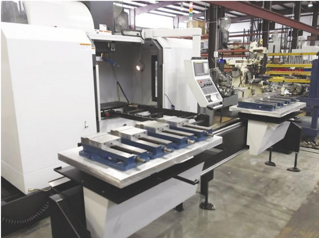
**Figura 4.1:** Macchina utensile *CNC* con aggiunta di un sistema di cambio pallet manuale.
