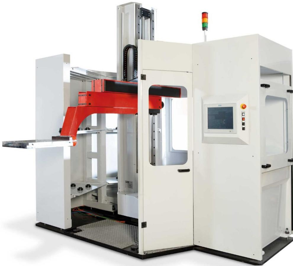
**Figura 4.4:** Sistema di cambio pallet automatico con manipolatore polare e telescopico integrato nel magazzino porta-pallet.
