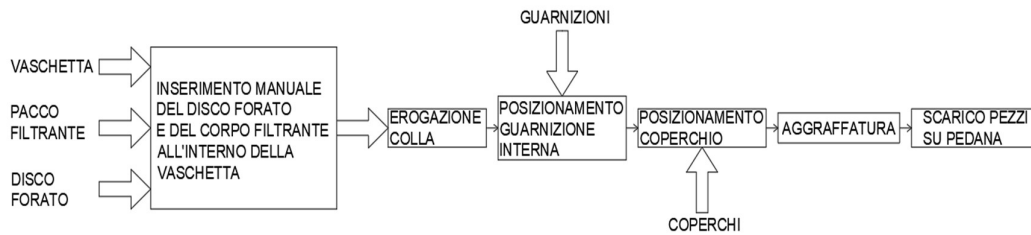
Figura 7.7: Prima parte del processo di assemblaggio dei filtri a tubetti
