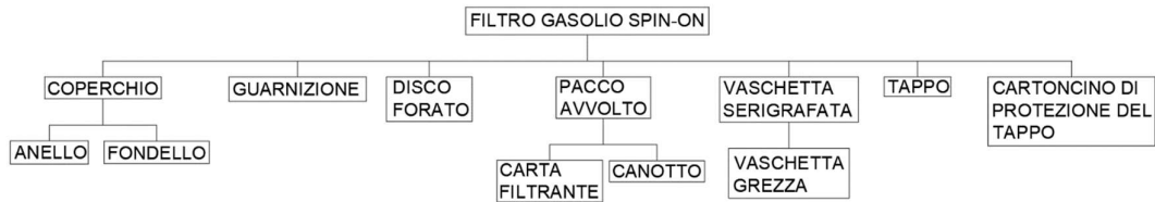
Figura 5.2: BOM del filtro gasolio Spin-on
