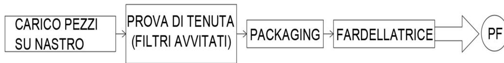
Figura 7.6: Seconda parte del processo di assemblaggio dei filtri avvitati
