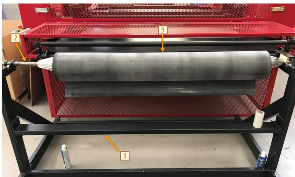
Figura 37 - Posizionamento rotolo di gomma sul carrello porta-rotolo.
