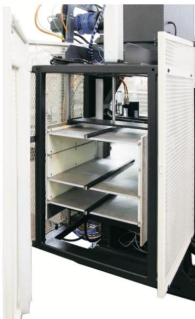
*Figura 30 - Dispositivo di cambio fustella*
