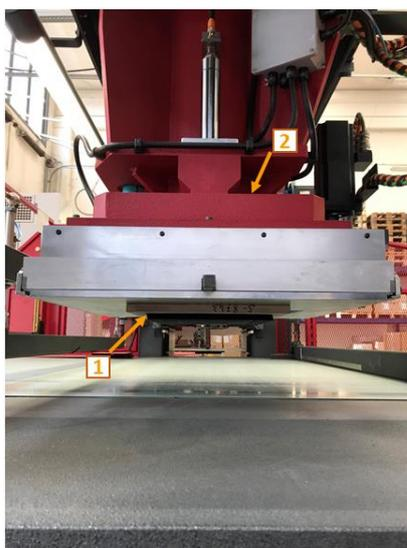
Figura 28 - Posizionamento fustella sulla testa tranciante. 1: Fustella; 2: Testa tranciante
