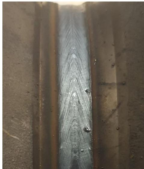
*Figura 6-38. Cordone di saldatura*
