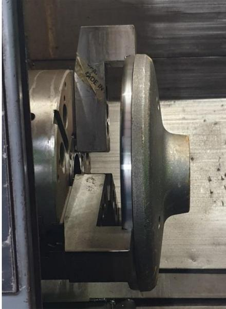
*Figura 6-8. Presa per la seconda lavorazione*
