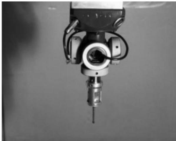
*Figura 6-12. Tastatore di misura*
