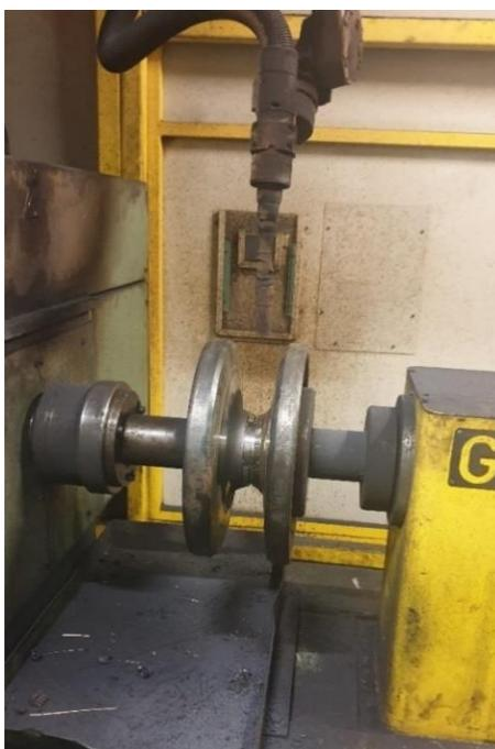
*Figura 6-35. Torcia di saldatura*
