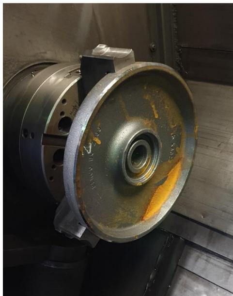
*Figura 6-6. Presa della ruota sul tornio attraverso l'autocentrante*
