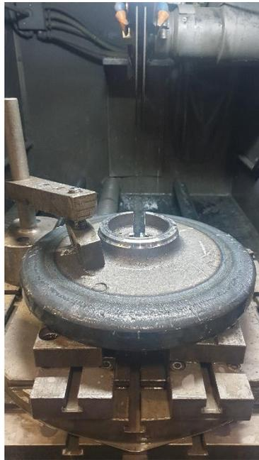
*Figura 6-22. Ottenimento del provino con una troncatrice*
