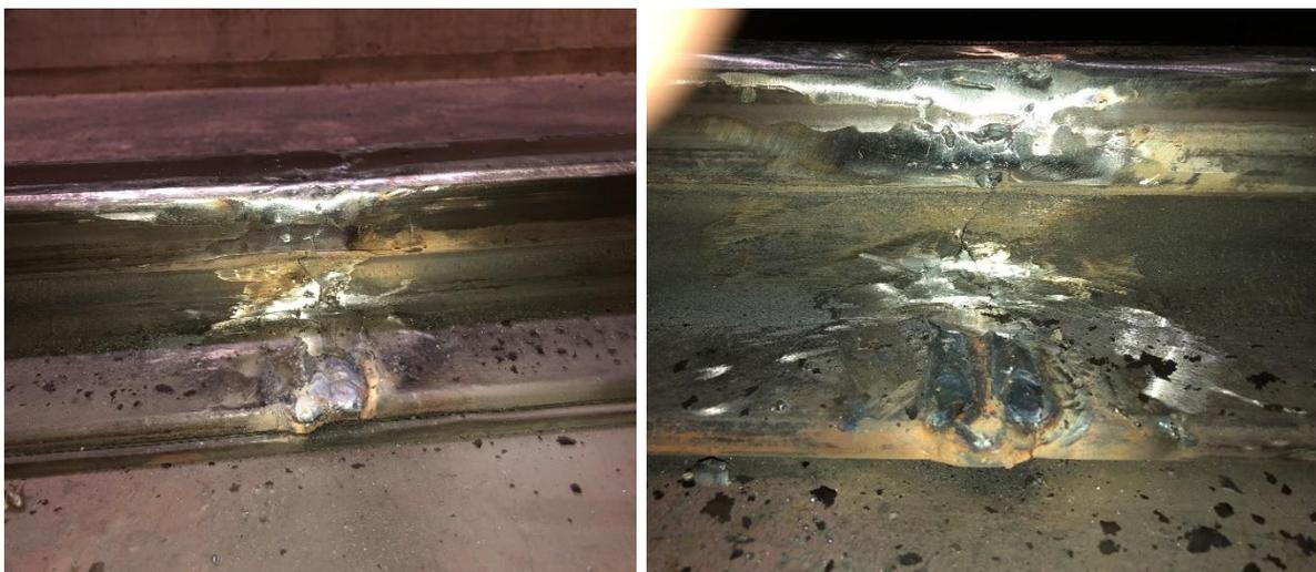
Figura 58)Foto che ritraggono la rottura propagata lungo tutto il cordone della giunta.
