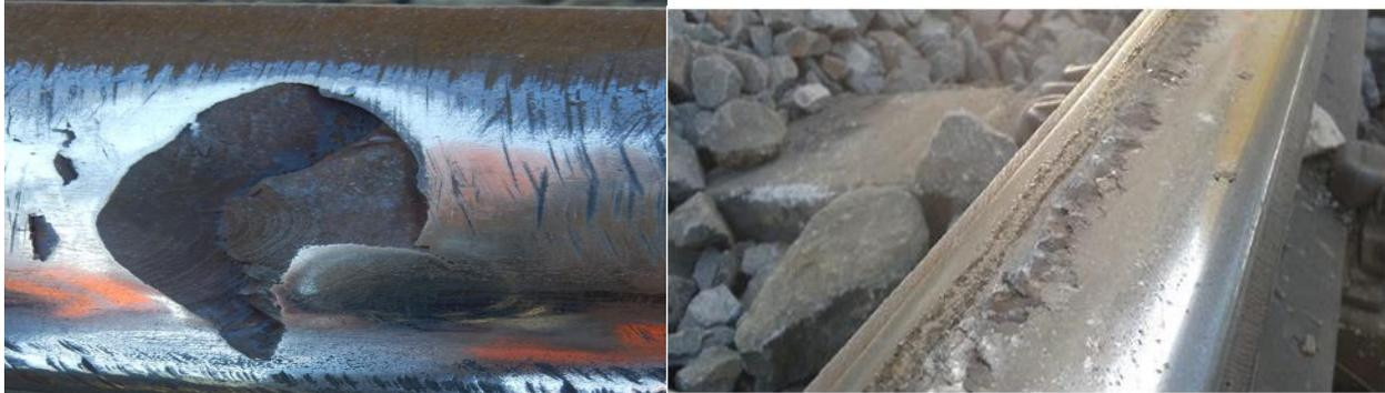
Figura 44) A sinistra un esempio di Spalling [4]. Il difetto si propaga in direzione longitudinale alla rotaia e si presenta come una fila di piccoli crateri. [41]
