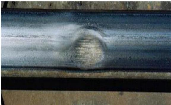
Figura 42) Esempio di un Wheel Burns di dimensioni grosse.[39]
