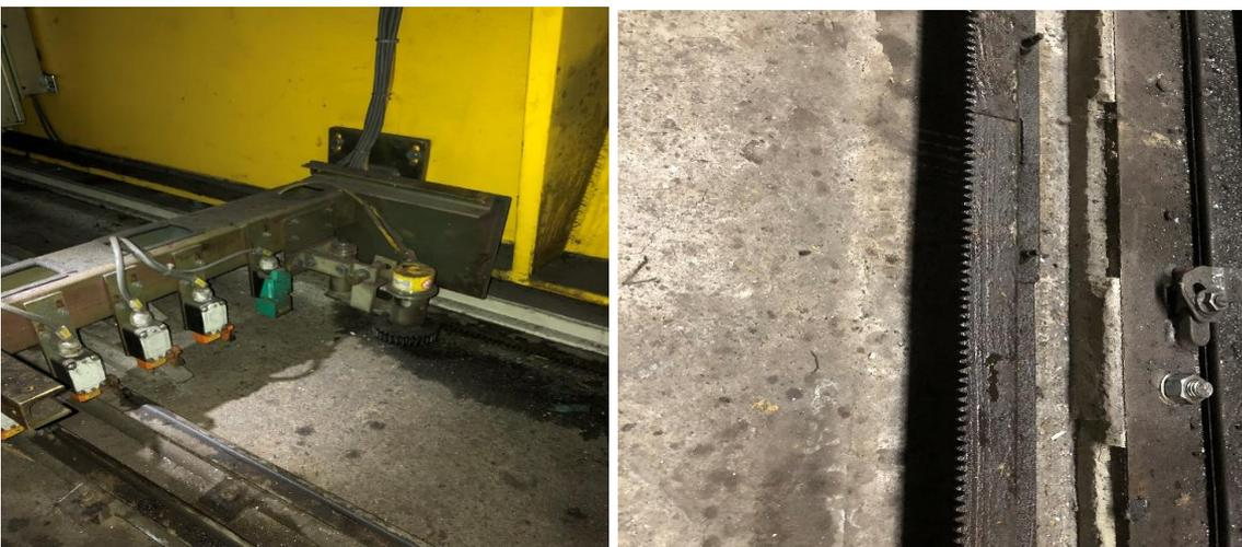
Figura 19) A sinistra, l'encoder assoluto che ingrana con una cremagliera per avere un riferimento e fermarsi nella giusta posizione. A destra, la cremagliera messa a lato della rotaia.
