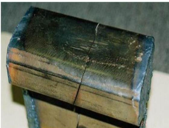
Figura 43) esempio di frattura causata da un eccessivo strato martensitico talmente fragile da dar via ad una propagazione totalmente verticale.[23]
