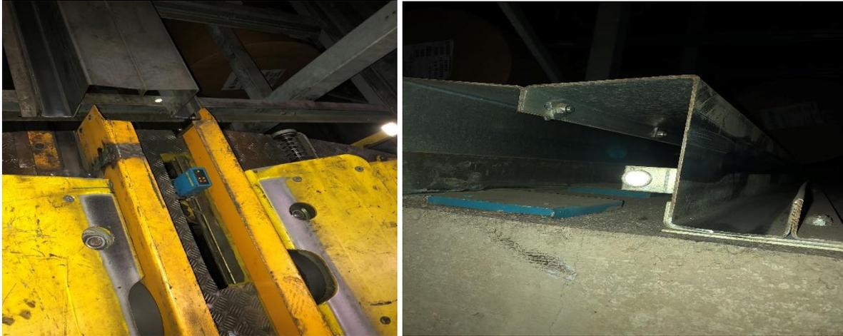
Figura 20) A sinistra, il sensore ad infrarossi montato sulla tavola rotante usato per l'allineamento. A destra il dischetto catarifrangente che proietta indietro il fascio ad infrarossi al sensore.
