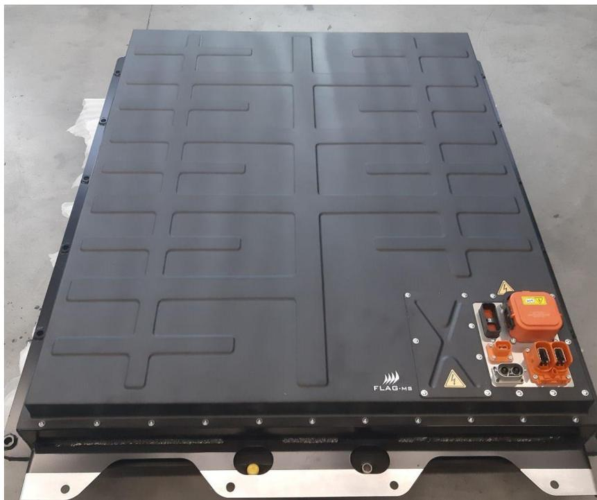
**Figura 2.5:** Pacco batteria FLAG-ms composto da 9 moduli in serie
