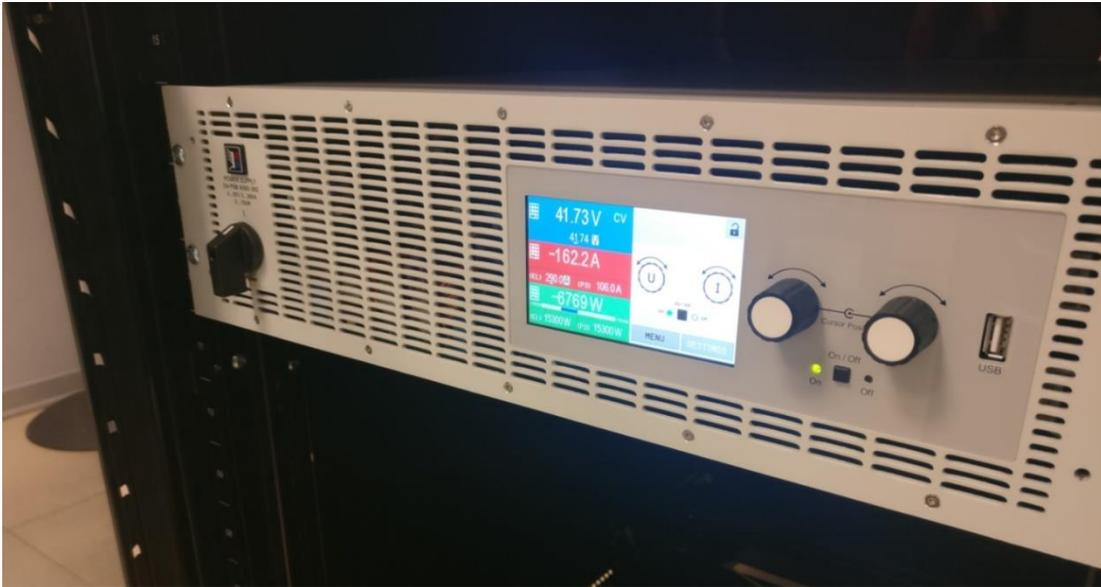
**Figura 2.11:** Ciclatore per test pacco batteria FLAG-ms[28]
